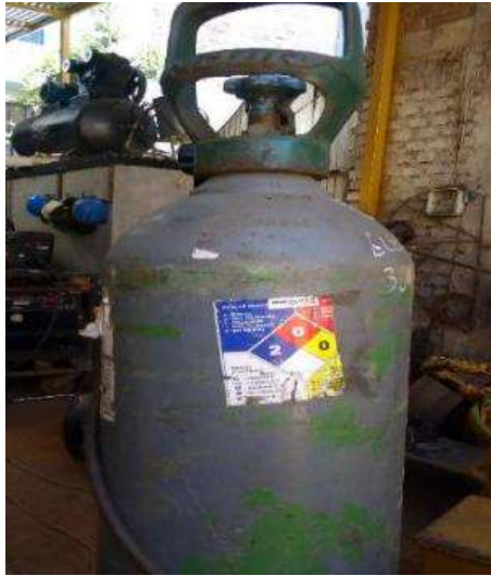
Material peligroso rotulado con tarjeta HMIS III
