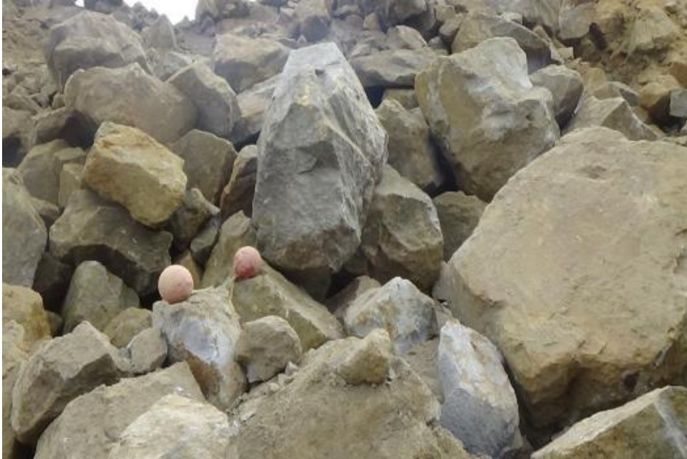
Voladura N°1, con densidad 0.80 reemplazando al ANFO.
