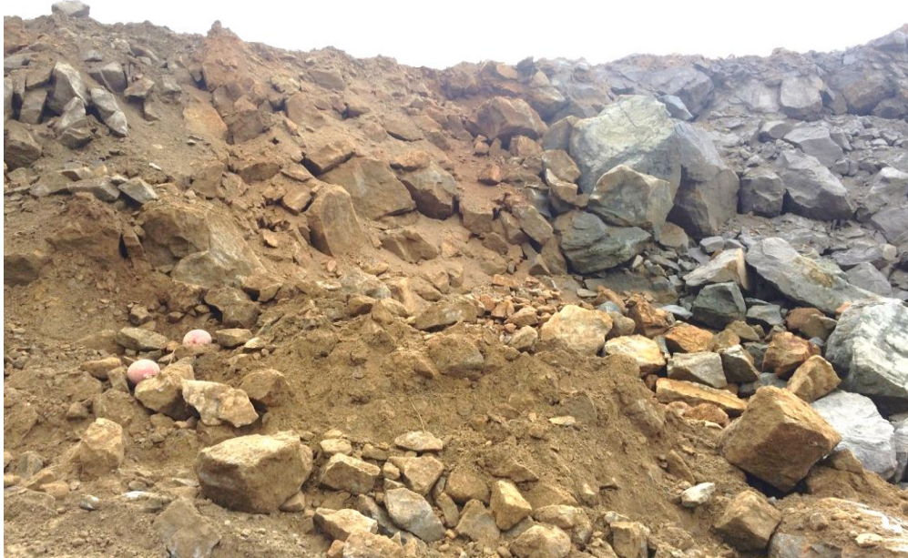
Voladura N° 2, densidad 1.0
