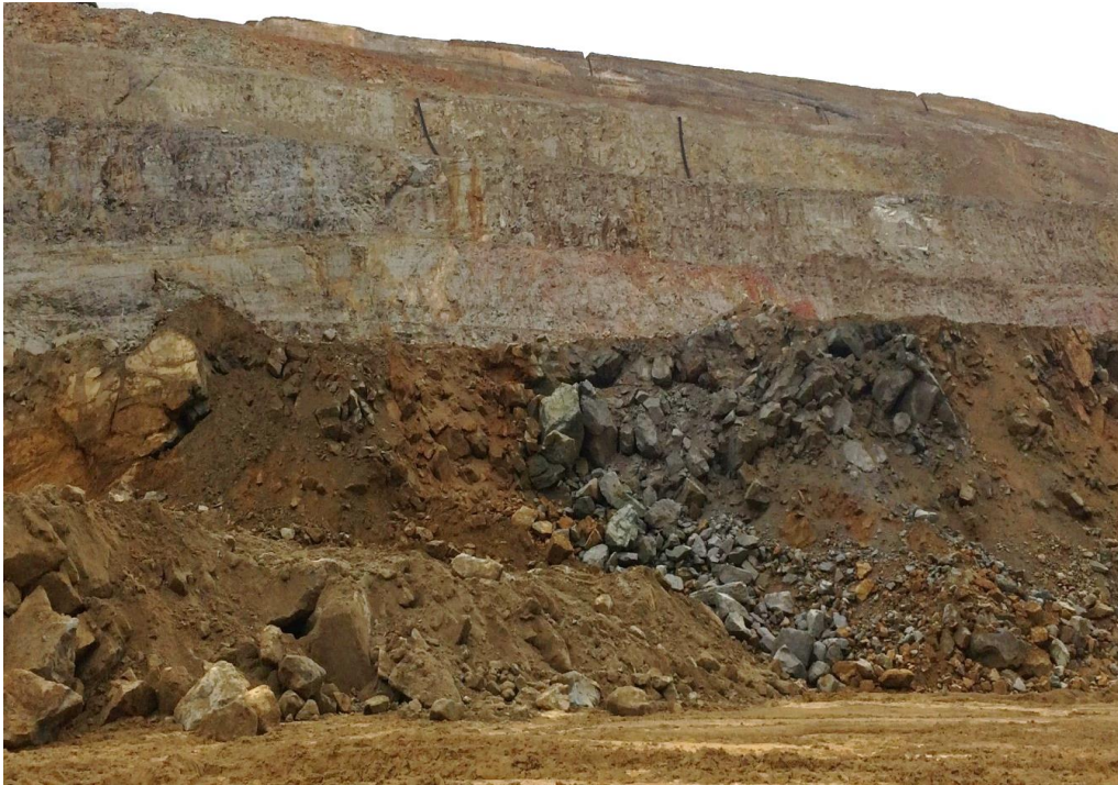
Voladura N°2, densidad 1.0
