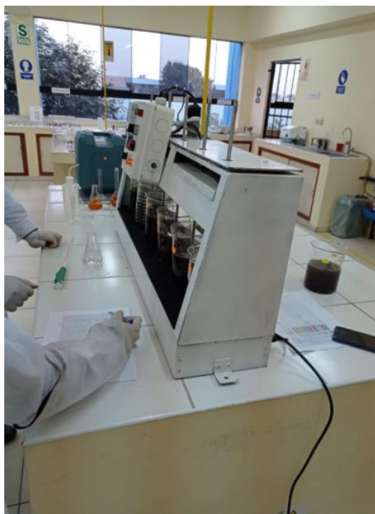
Sistema de Test de jarras para la coagulación y floculación
