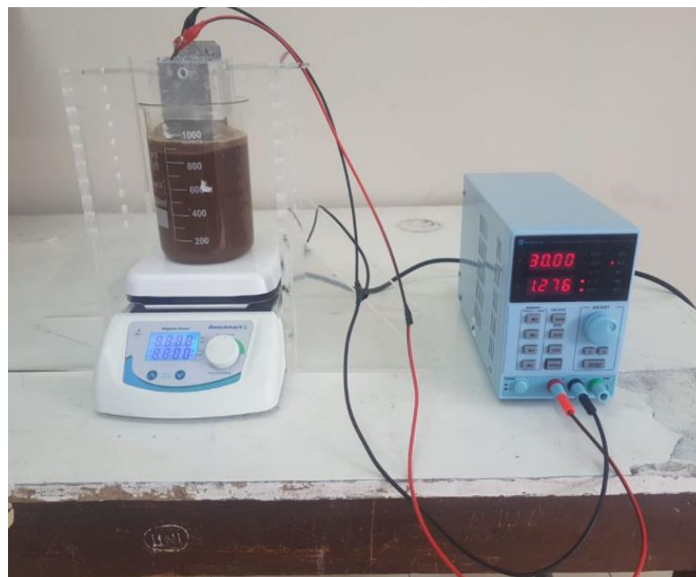
Figura 11 Sistema de electroremediación implementado en laboratorio
