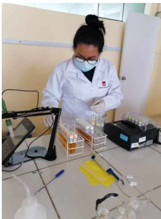
Análisis de la DQO con el digestor y viales
