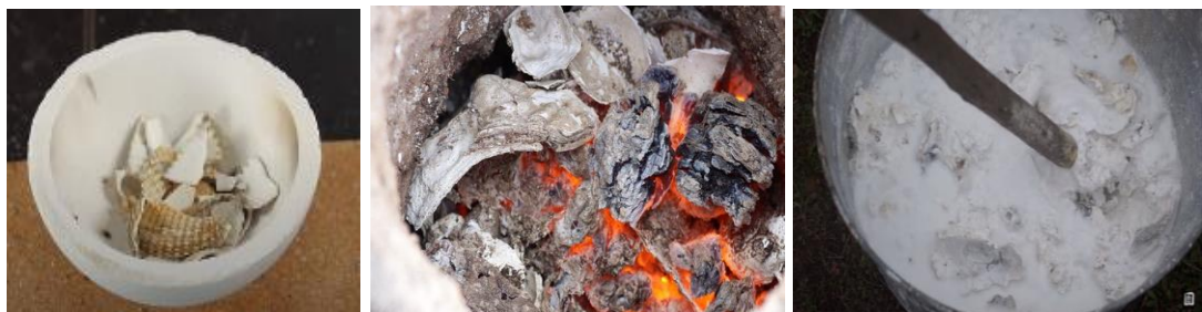
Figura 5. Proceso de calcinación de valva de moluscos
