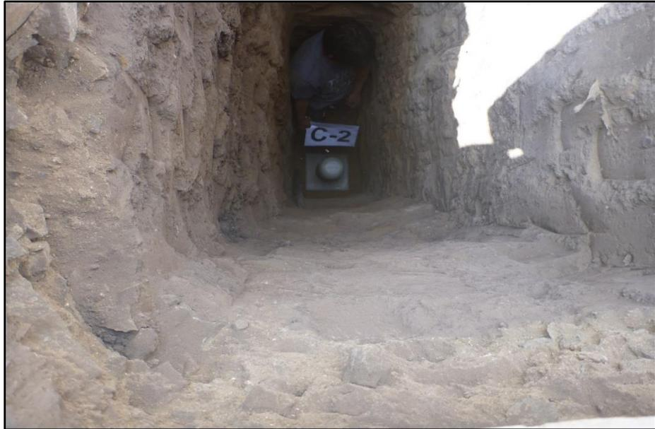
**Imagen 2.** *Vista de la Calicata C-2 con ensayo de densidad*
