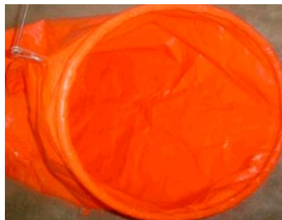
Figura 9. Manga de ventilación
