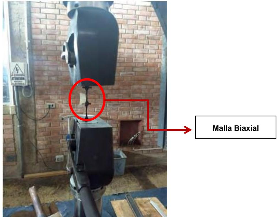
**Figura 3.13:** Ensayo a tracción de una costilla de la geo malla.
