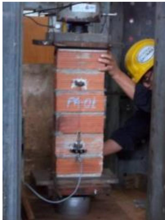
**Figura 3.10: Ensayos a compresión de ladrillo pandereta**
