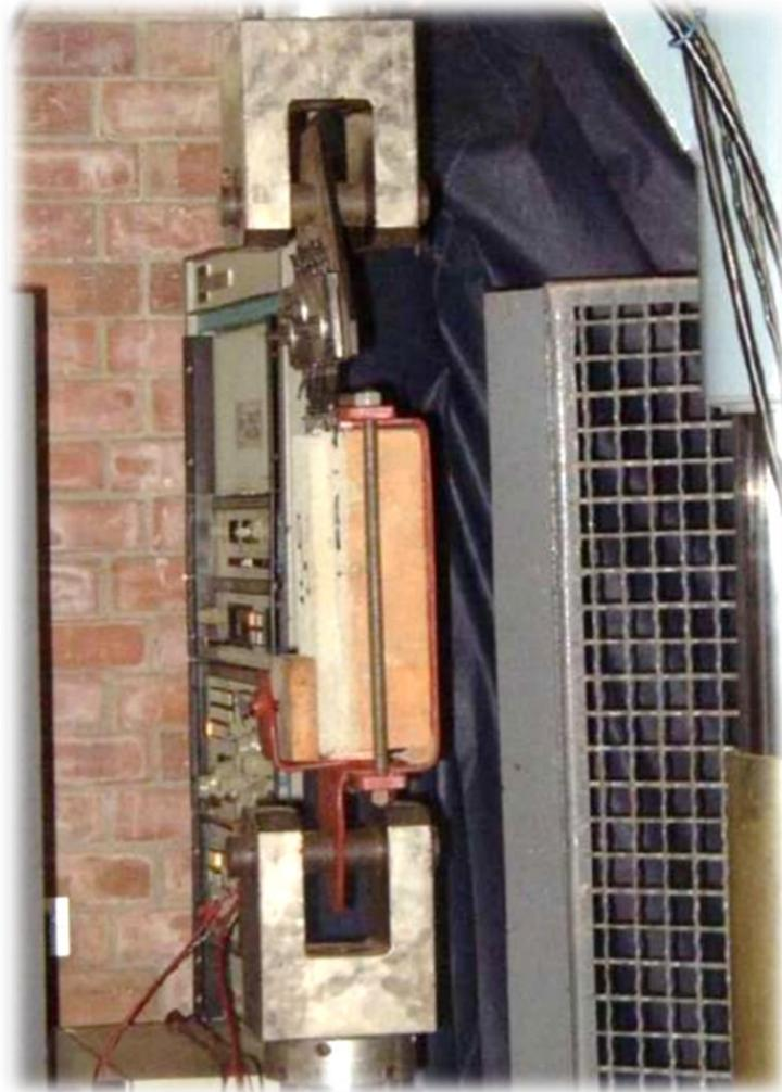
**Figura 1.13: Dispositivo utilizado para el Ensayo de Adherencia**
