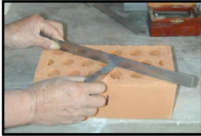
**Figura 3.5: Ensayo de alabeo de ladrillo King Kong**
