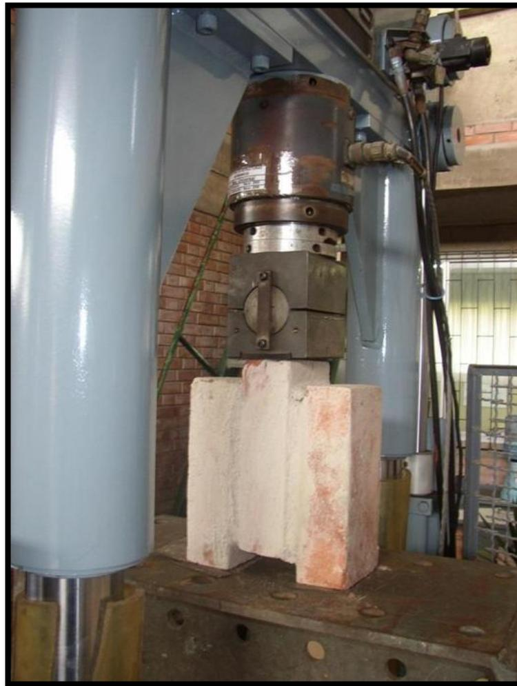
**Figura 3.15: Ensayo de tripletes de mampostería a corte directo.**
