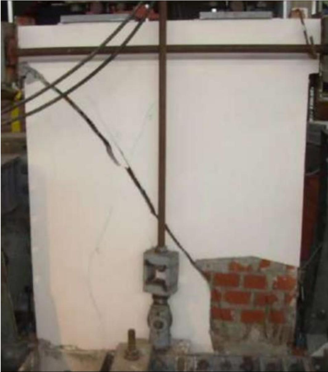
**Figura. 1.2: Ensayo cíclico corte-compresión sobre muro tarrajado.**
