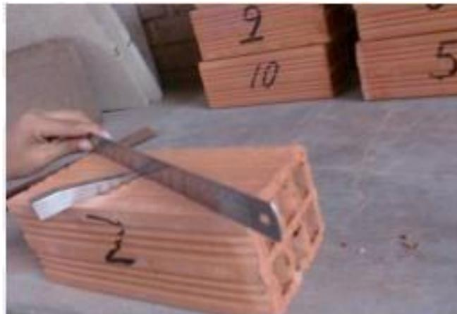
**Figura 3.6: Ensayo de alabeo de ladrillo pandereta**
