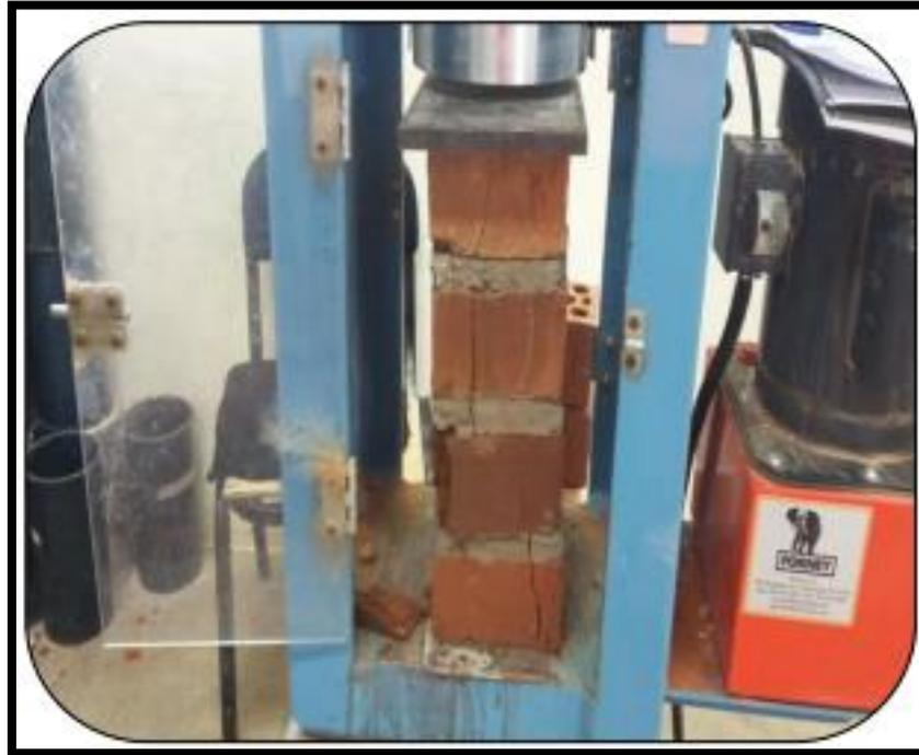
**Figura 3.9: Ensayos a compresión de ladrillo**
