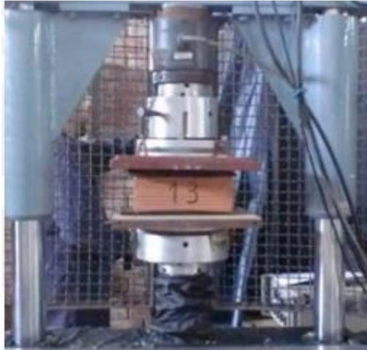
**Figura 3.8: Ensayos a compresión de ladrillo pandereta**
