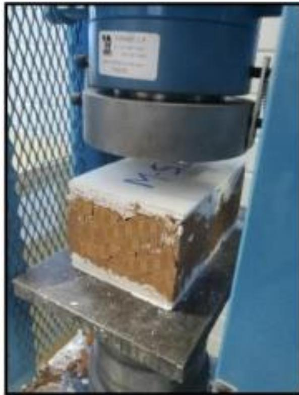
**Figura 3.7:** Ensayos a compresión de albañilería.
