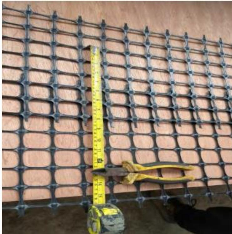
**Figura 3.12: Geo malla biaxial a usar para el sistema de reforzamiento FRCM.**
