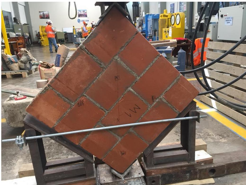
**Figura 1.35: Compresión diagonal de un murete de albañilería**
