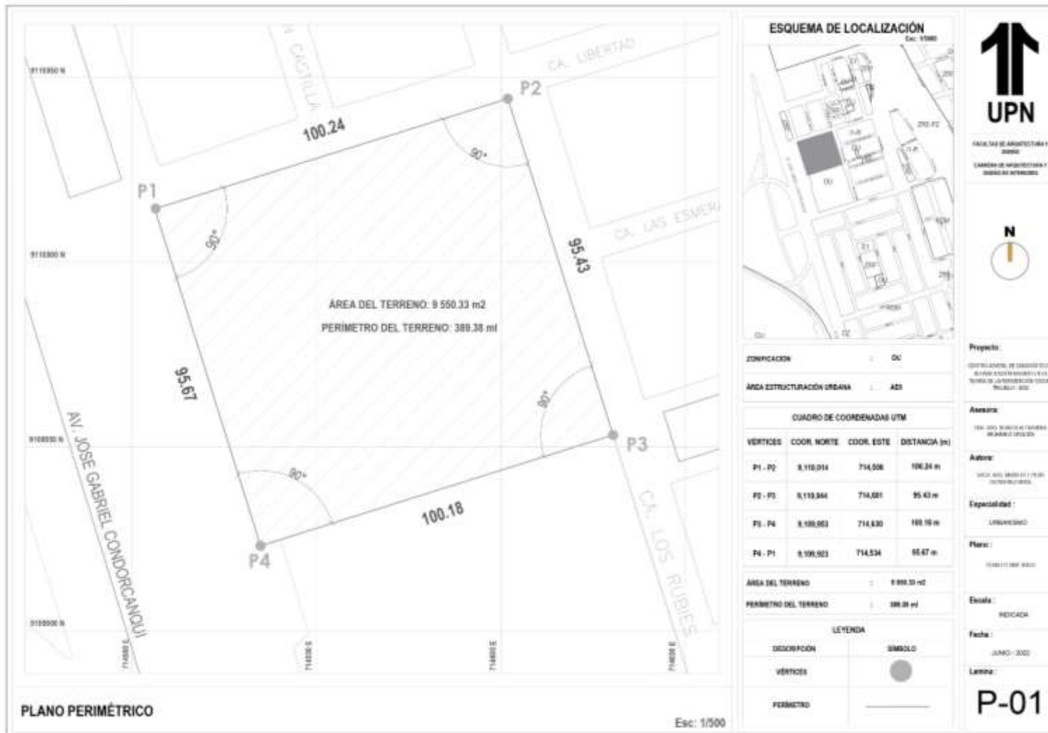
Figura 39. Plano perimétrico del terreno
