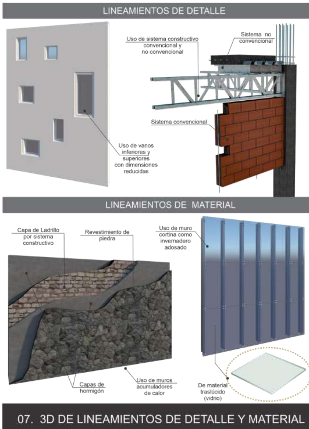
Figura 74: 3D de lineamientos de detalle y materiales
