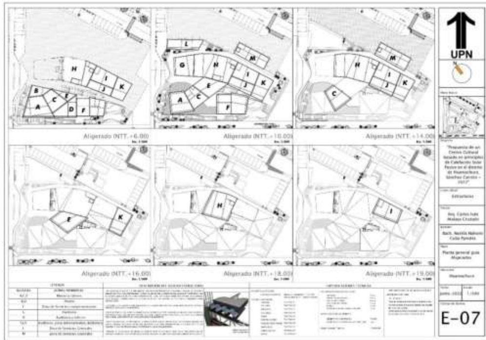
Figura 139: Plano guía de aligerados por nivel
