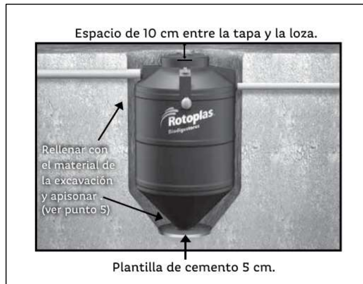
Figura 1: Medidas de excavación para la ubicación del tanque
