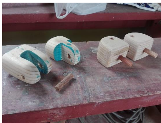
Figura 51: Los tarugos serán los ejes para el giro de las piezas.
