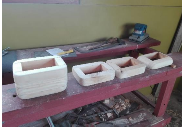
Figura 46: Marcos encolados entre sí, dándole forma al torzo del juguete
