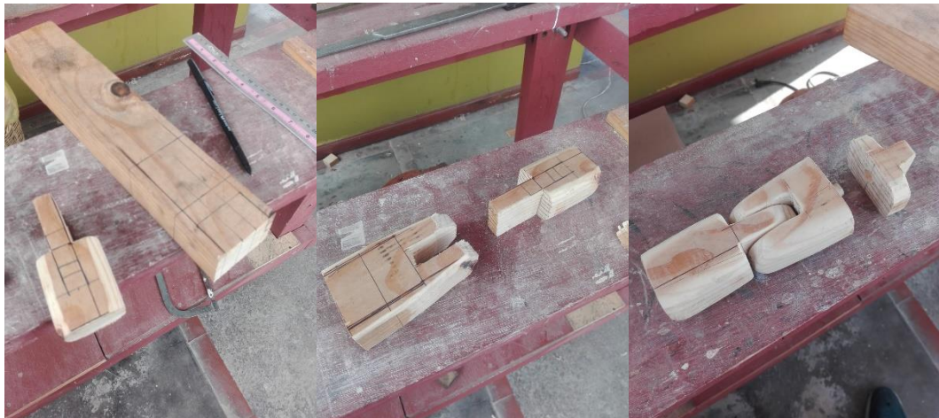
Figura 18: Secuencia del proceso de elaboración de un modelo del brazo del juguete
