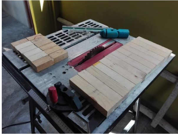
Figura 42: Corte del listón de madera pino (1 ½ x 2 x 10,5)
