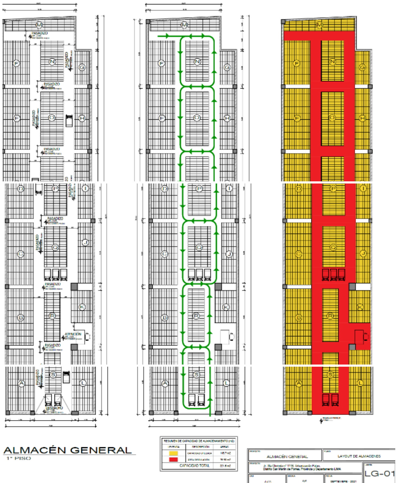
Figura 43: Layout – Almacén General de primer nivel.
