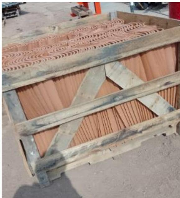
*Figura 20: packing de tejas*
