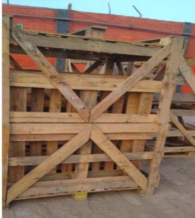
*Figura 28: pallet modificado para tejas*
