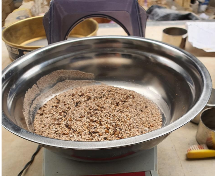
Fotografía 7. Acumulación de la muestra retenida en el lavado.
