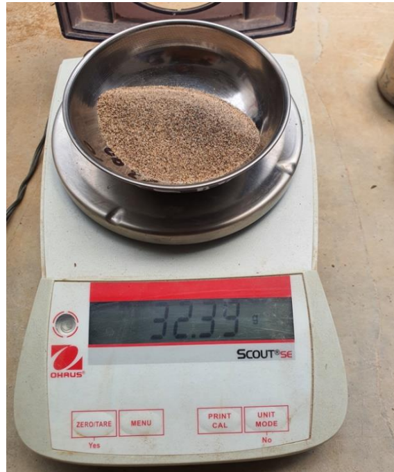
Fotografía 9. Peso de la muestra retenida por tamiz de granulometría por lavado.
