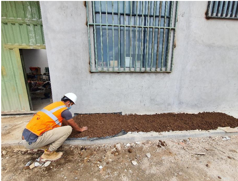
Fotografía 15. Investigador secando la muestra al aire libre para el ensayo de Proctor modificado y CBR.
