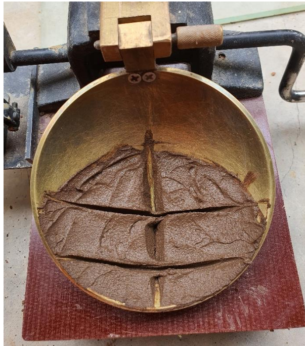
Fotografía 13. Dos mitades de la muestra en contacto por 1.27cm.
