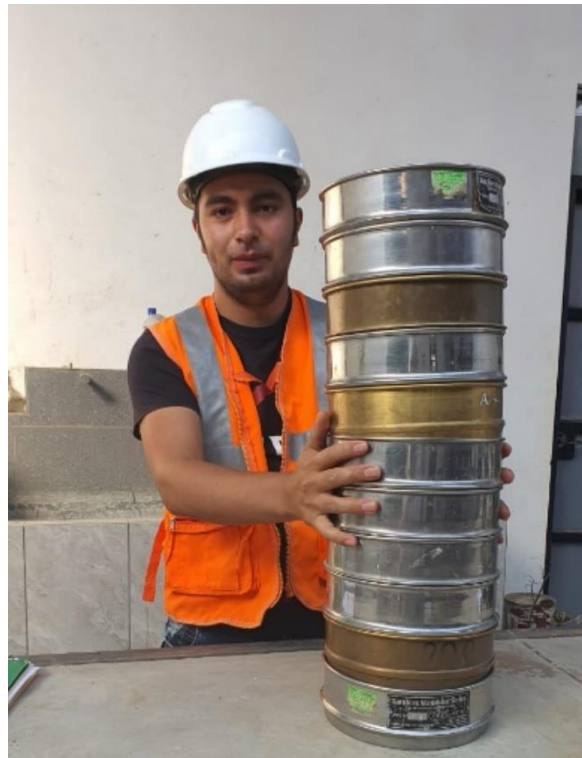
Fotografía 8. Investigador realizando el tamizaje de la muestra retenida en el lavado.
