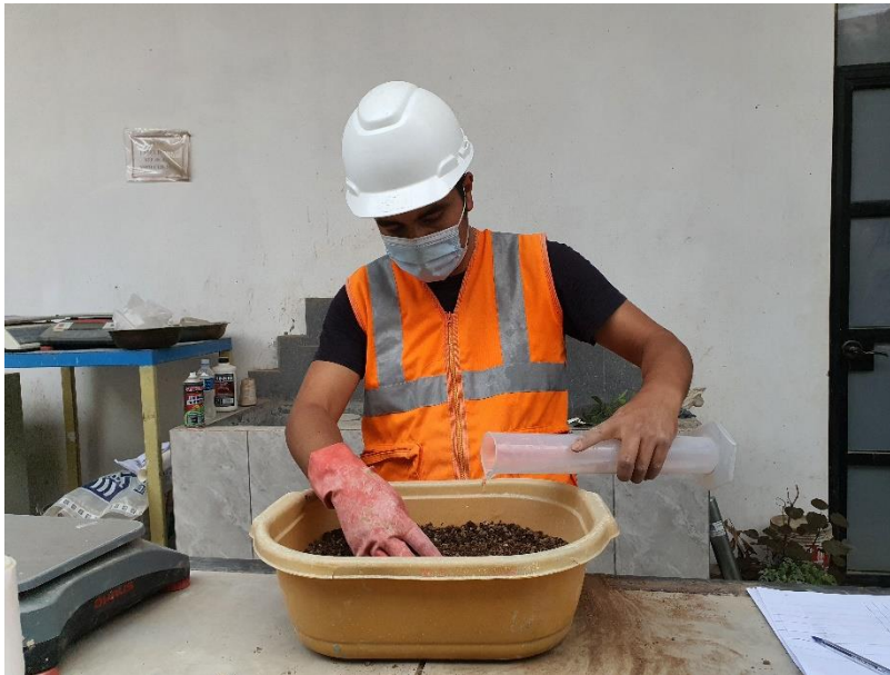
Fotografía 17. Investigador realizando la mezcla de la muestra para Proctor modificado.
