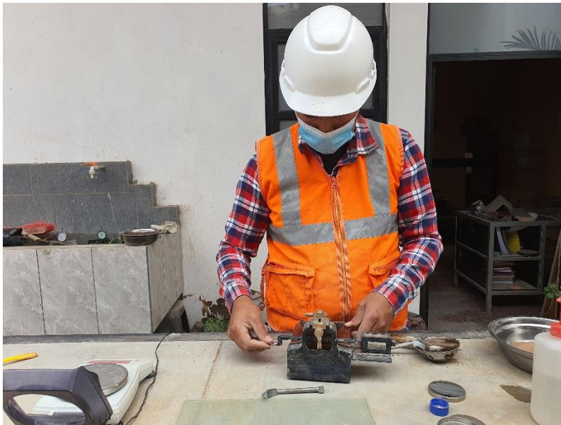
Fotografía 12. Investigador realizando el proceso del número de golpes hasta que las dos mitades del suelo se pongan en contacto.
