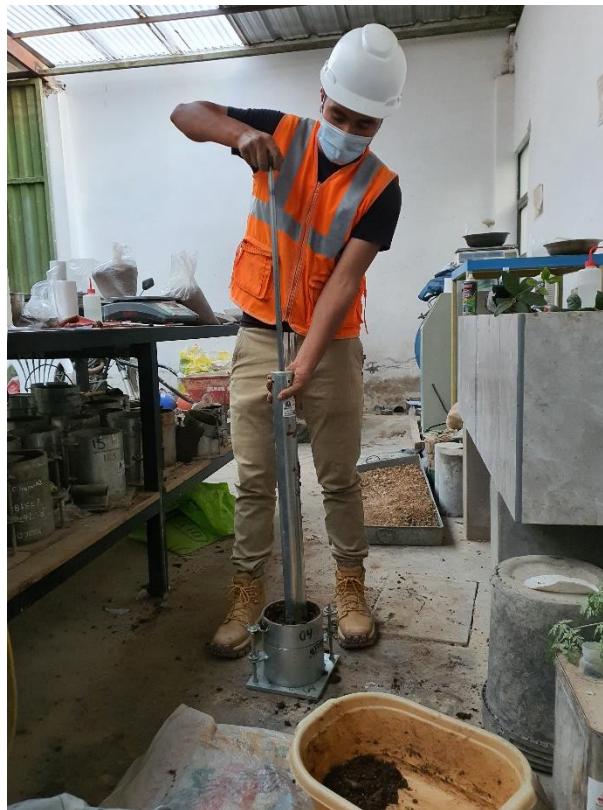
Fotografía 18. Investigador apisonando la muestra para Proctor modificado.
