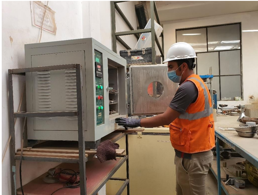
Fotografía 5. Investigador realizando su estudio de contenido de humedad a 110°C.
