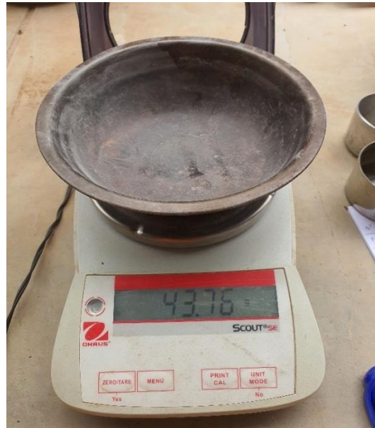
Fotografía 3. Peso de recipiente para contenido de humedad.
