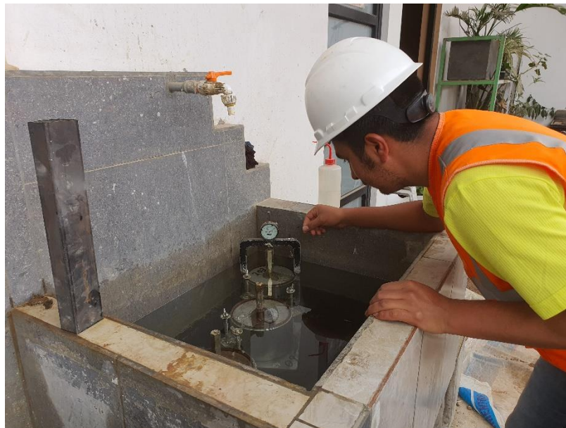
Fotografía 20. Investigador tomando datos de hinchamiento del ensayo de CBR.
