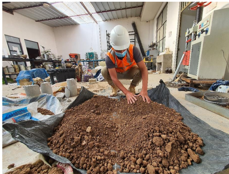
Fotografía 16. Investigador cuarteando la muestra para el ensayo de Proctor modificado.
