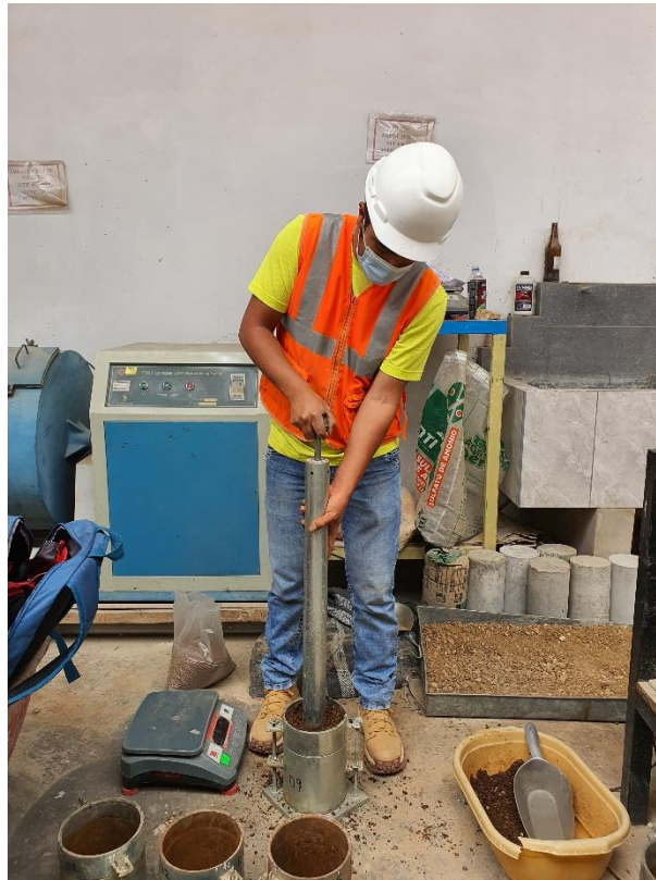
Fotografía 19. Investigador realizando la compactación para CBR.
