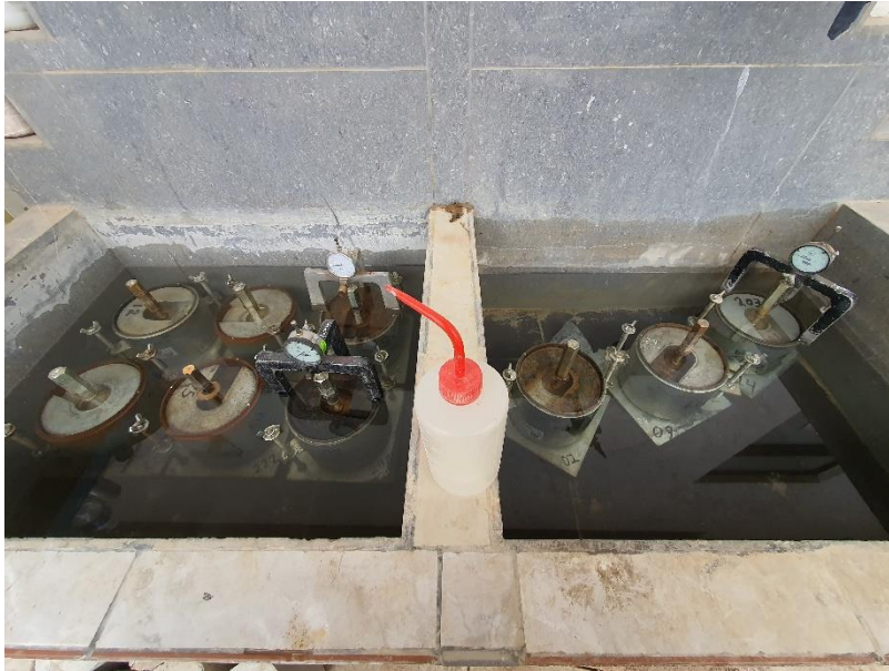
Fotografía 21. Hinchamiento del ensayo CBR.
