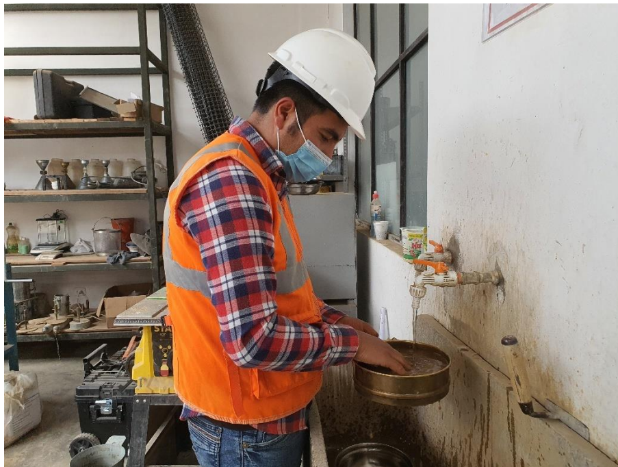
Fotografía 6. Investigador realizando el lavado de la muestra para granulometría por lavado.
