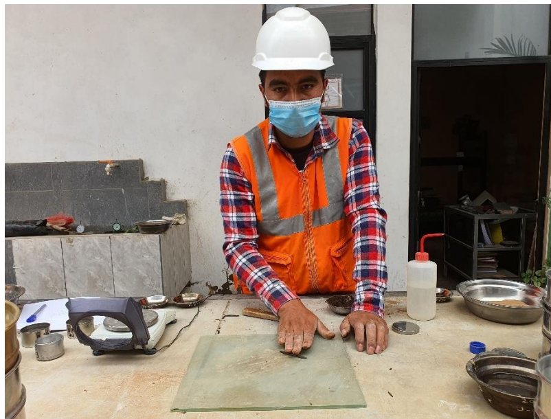
Fotografía 14. Investigador enrollando la muestra sobre una placa de vidrio para límite plástico.
