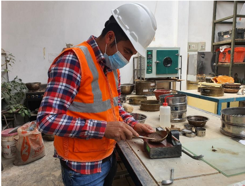
Fotografía 11. Investigador realizando el enlace en la copa de Casa Grande para limite líquido.
