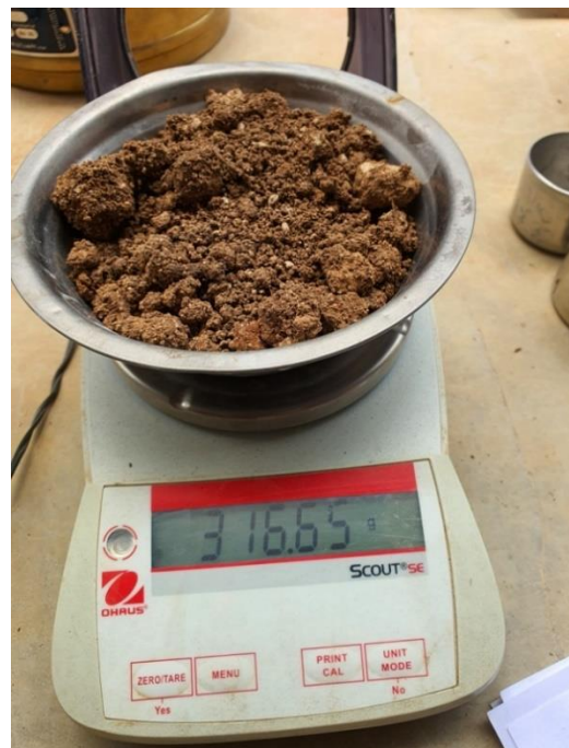
Fotografía 4. Peso de la muestra de estudio para contenido de humedad.
