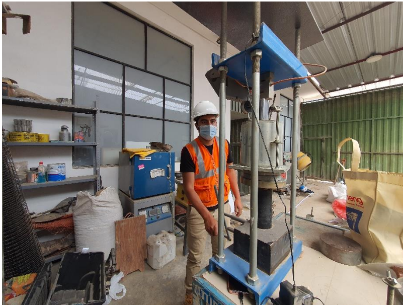
Fotografía 22. Investigador realizando penetración de CBR.
