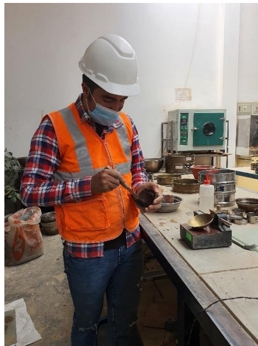
Fotografía 9. Peso de la muestra retenida por tamiz de granulometría por lavado.
