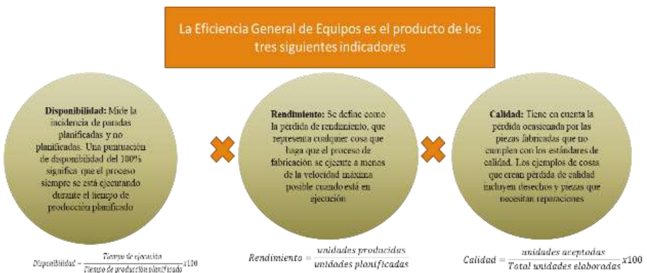
Figura 9. Estructura de la eficiencia global de equipos.
