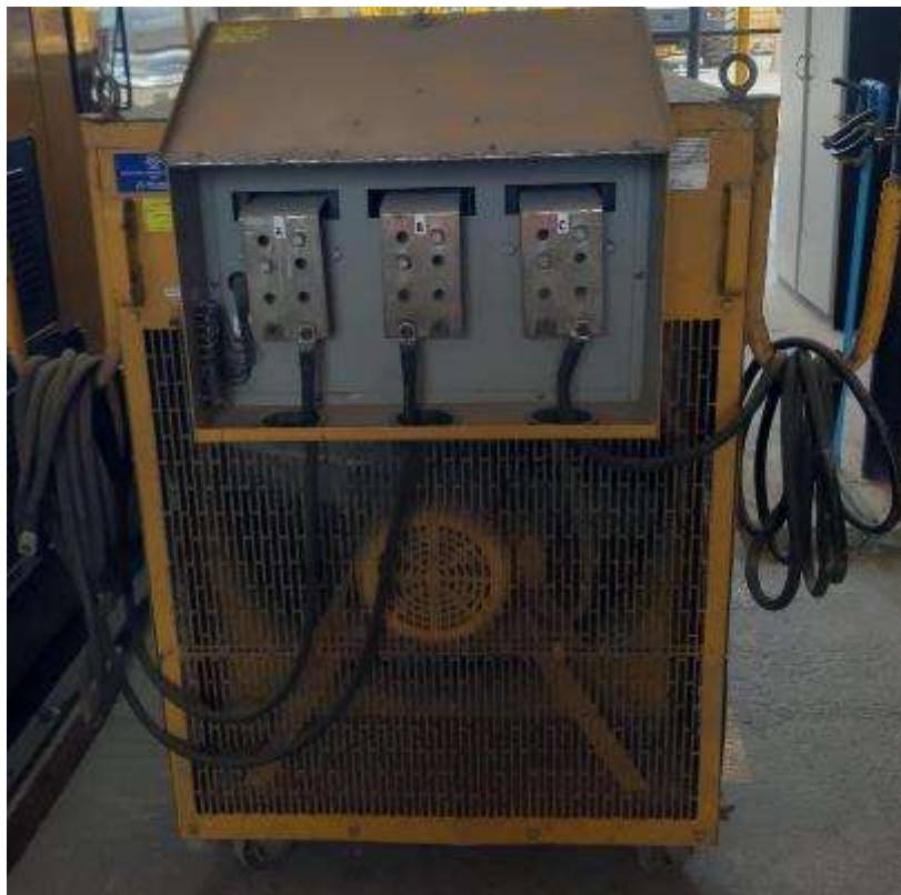
Figura 21. Banco de prueba con carga eléctrica Avtron
