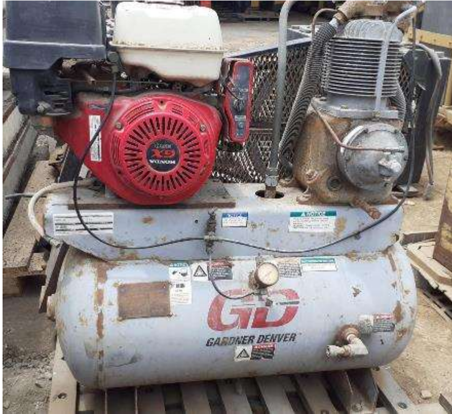
Figura 20. Compresora de aire Gardner Denver
