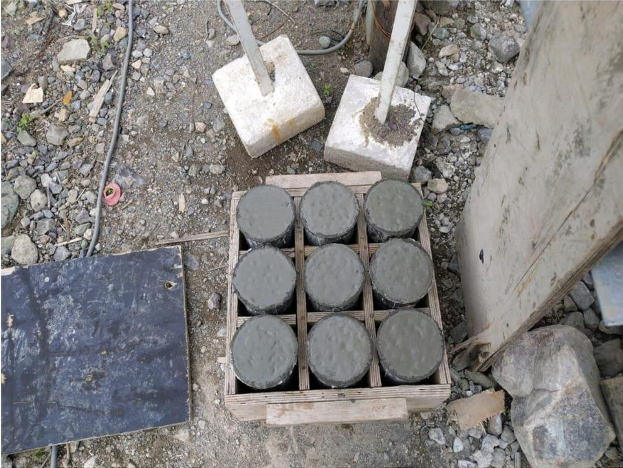
Fotografía 6: Curado de probetas de concreto 7, 14 y 28 días.
