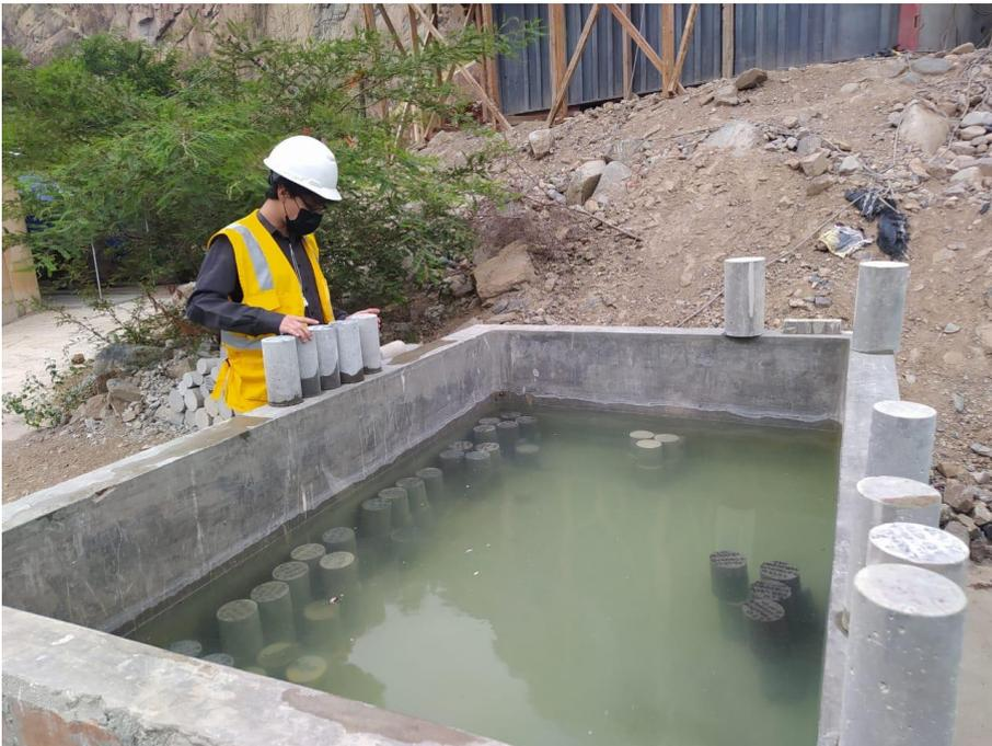
Fotografía 7: Medición del área de probeta.
