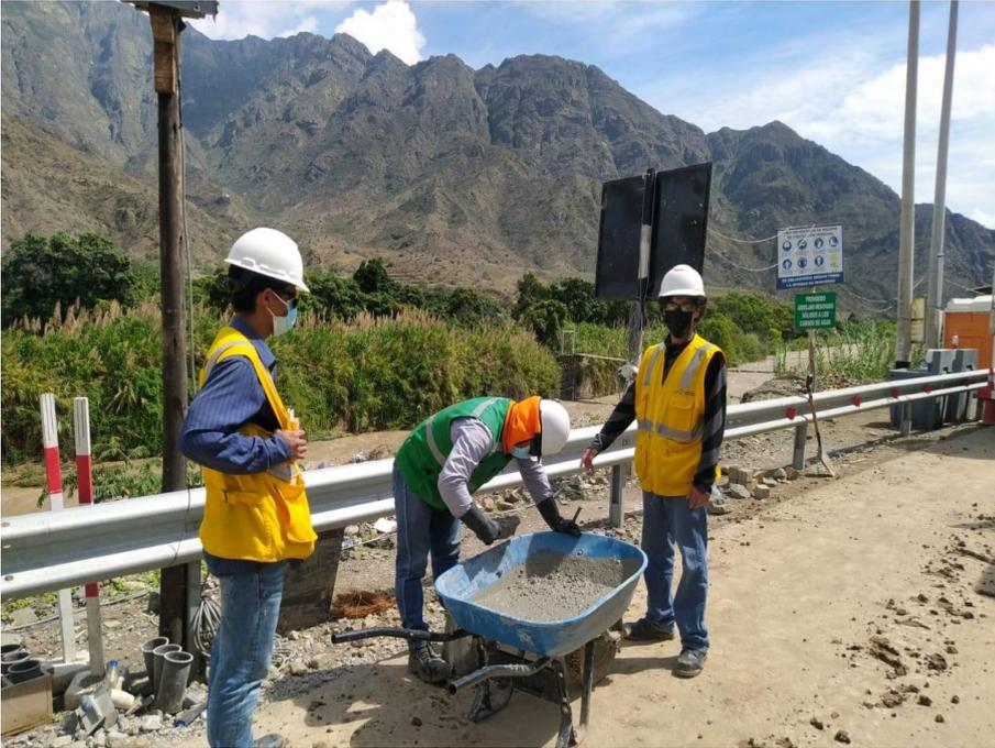
Fotografía 4: Temperatura del concreto premezclado.
