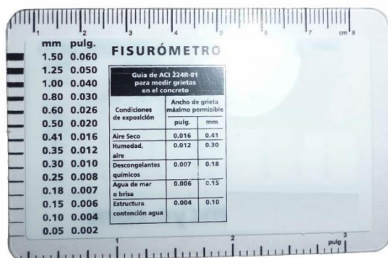
Figura 22: Tarjeta de comparación de fisuras
