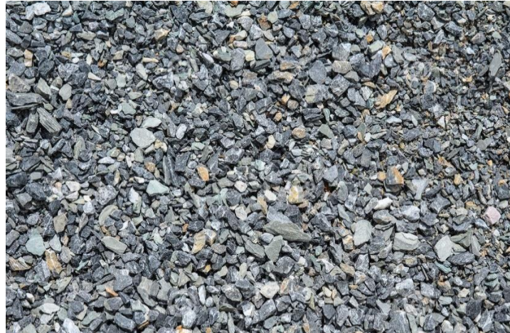
Figura 05: Agregado grueso o grava
