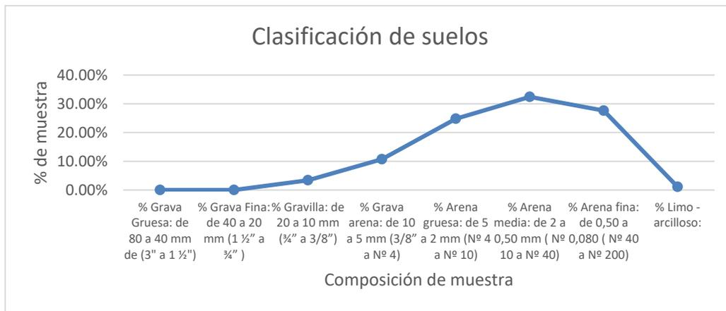
*NOTA: En la Figura 8, se puede observar que el pico más alto se ubica en el punto de 32.40% y se le ubica en tipo de Arena media, ya que a sus costados se distribuye entre arena fina y arena gruesa y se corrobora en el ANEXO 6, donde se verifica que la muestra es Arena Limosa o arcillosa tipo A-2-6 (0) bien gradada.*
