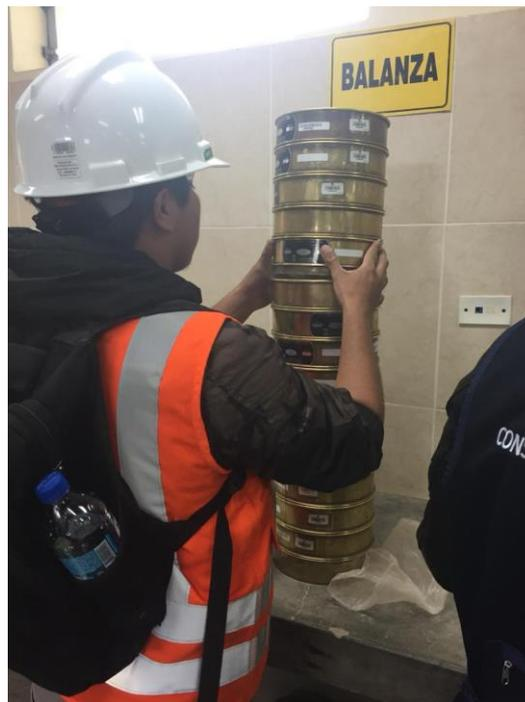
**Figura 18:** *Análisis Granulométrico*
