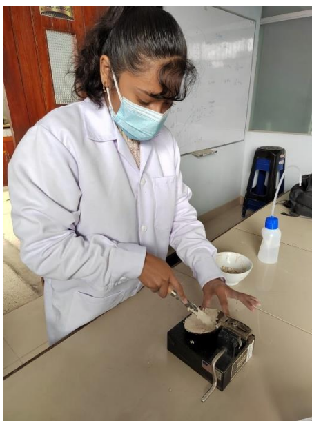
ANEXO 3.2: Ensayo de Límite Líquido en la cuchara de casagrande
