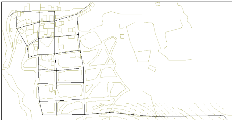
Figura 28: Captura de Pantalla del programa WaterGEMS correspondiente al resultado final del modelamiento de la Red de Distribución, elaborado por Juan de Jesús Valdez Barón.
