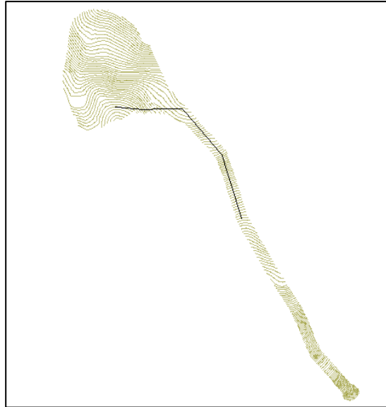
Figura 17: Captura de Pantalla del programa WaterGEMS, correspondiente al trazo de la LA y el fondo de Curvas de Nivel elaborado por Juan de Jesús Valdez Barón.
