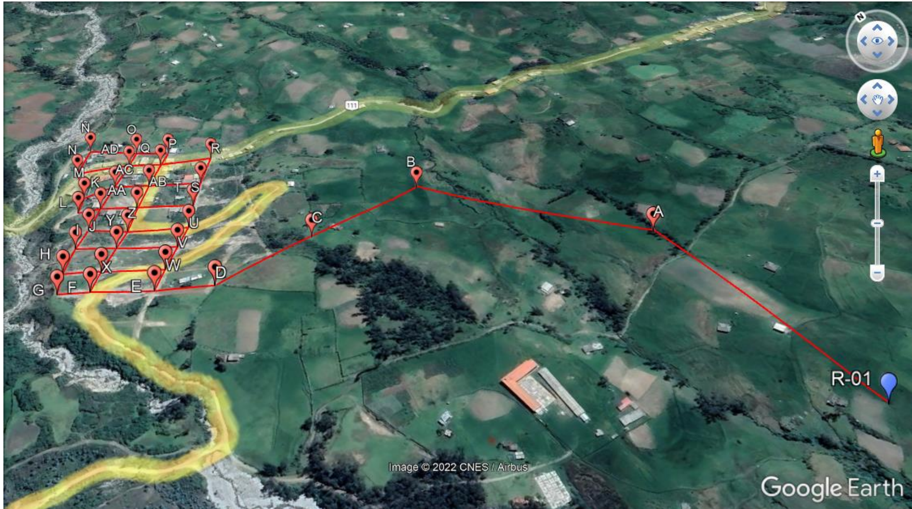
Figura 51: Reservorio 01, línea de aducción y la red de distribución ubicado y obtenido por Google Earth Pro.
