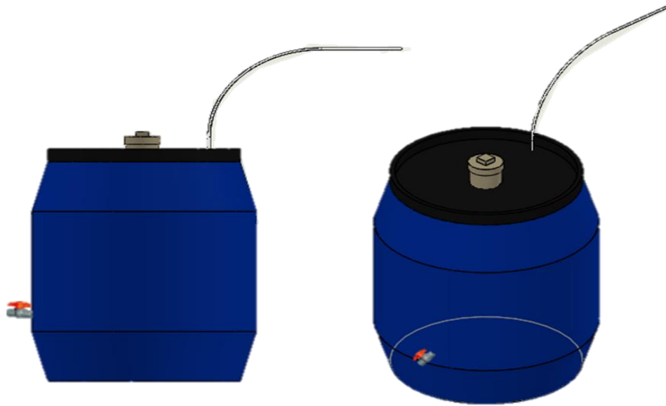
Figura SEQ Figura \* ARABIC 11: Modelado 3D del biodigestor anaerobio de régimen discontinuo (BATCH). Fuente: SolidWorks 2018.
