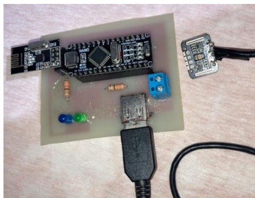
Figura 36: Resultado final de la tarjeta de adquisición y transmisión de datos.
