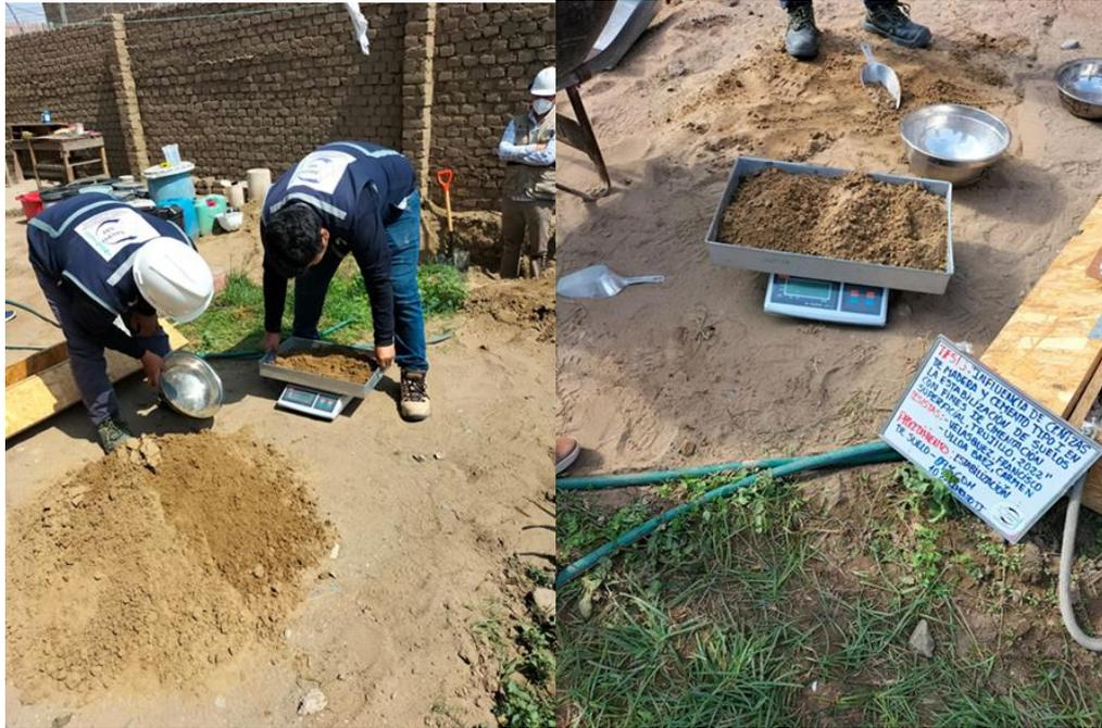
Fotografía 11. Extracción y peso de muestras del suelo natural.
