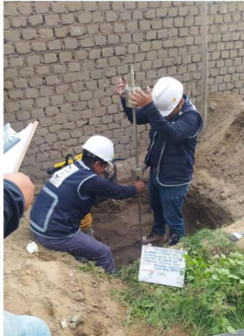
Fotografía 12. Ensayo de DPL en muestra natural.
