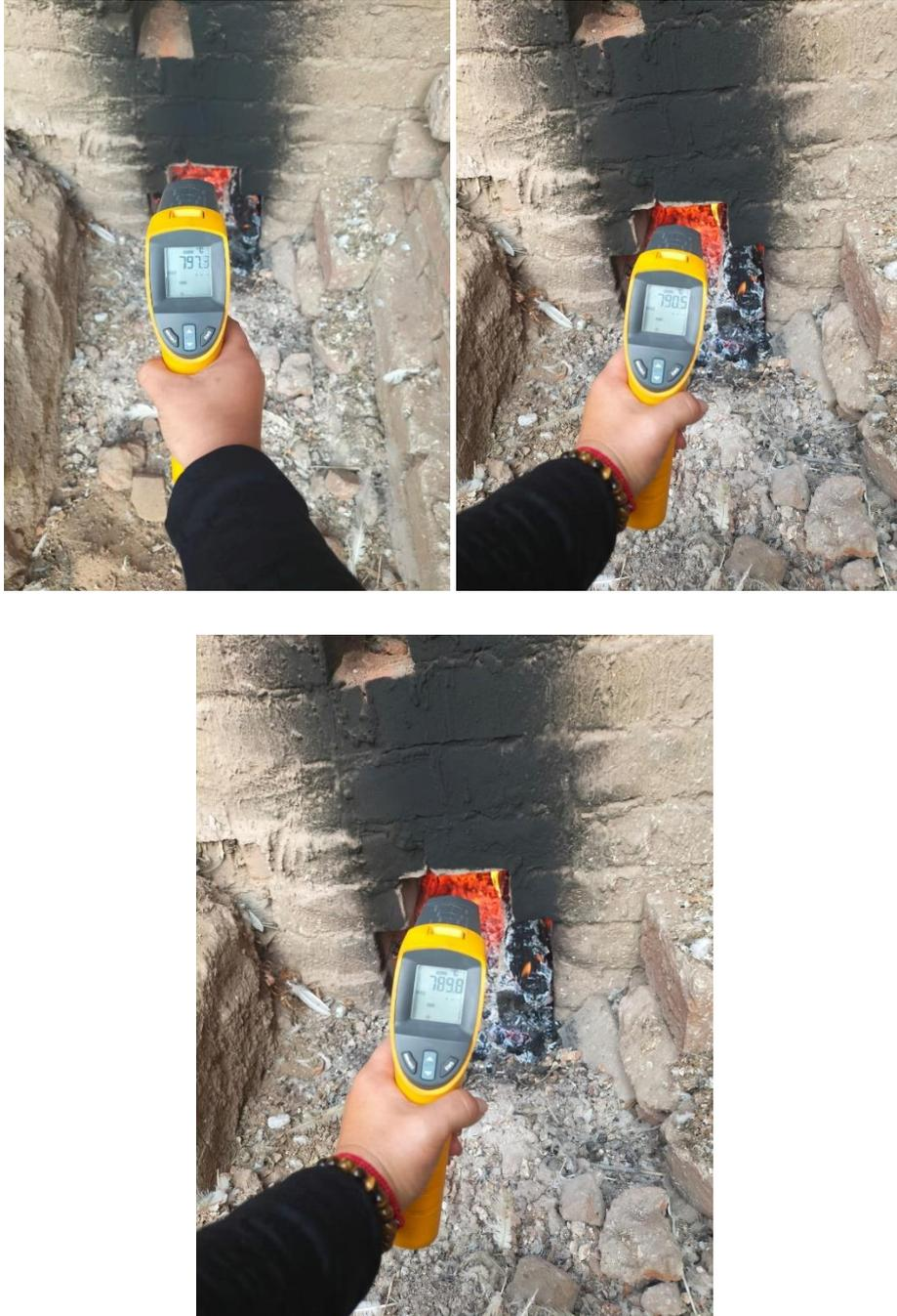
Fotografía 6. Toma de temperatura con el pirómetro de tres lectura diferentes.
