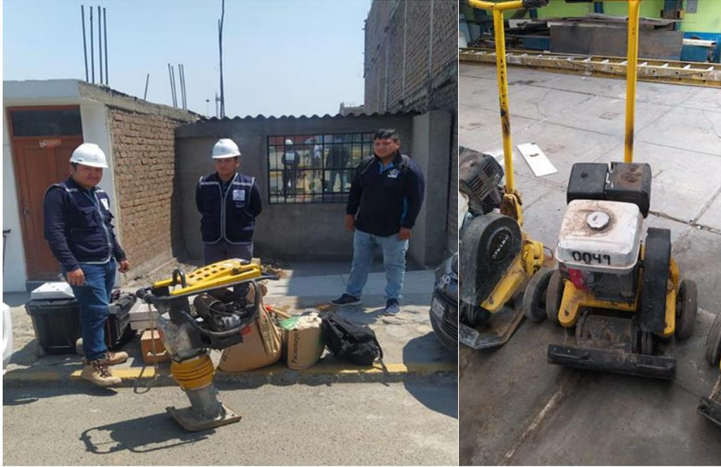
Fotografía 7. Maquinaria para la compactación de estabilización de estrato.
