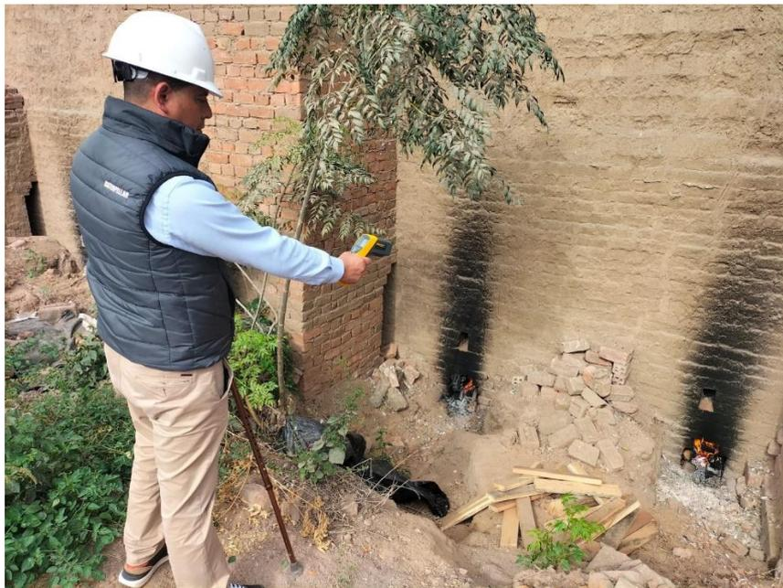
Fotografía 5. Proceso de incineración de material orgánico madera Copaiva (combustible). y toma de temperatura con el pirómetro.
