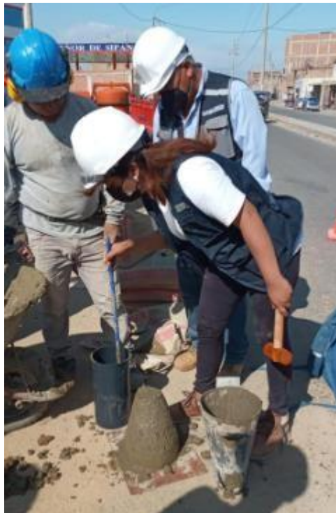
Foto N°08: Ensayo de asentamiento de concreto NTC 396
