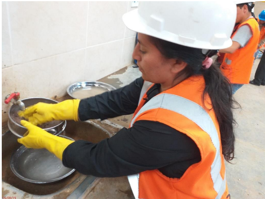
FOTO 10: Lavado de muestra de suelo por la malla N° 200, para ensayo granulométrico.
