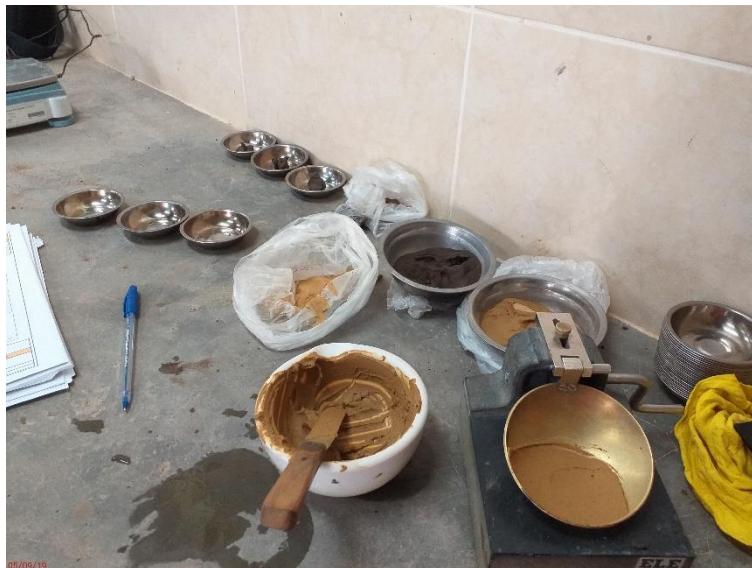
FOTO 12: Ensayo de Límites de Consistencia, preparación del material.
