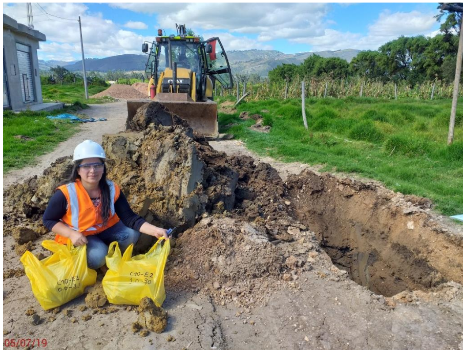
FOTO 6: Material existente en las calicatas, dos estratos diferenciados en calicata C10.
