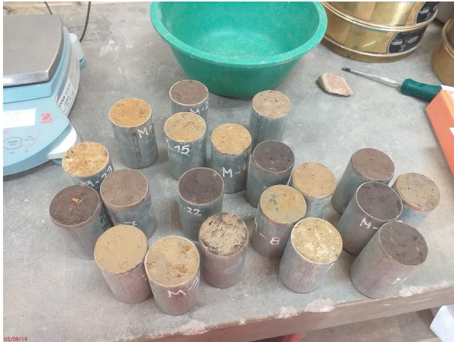
FOTO 7: Muestras inalteradas, para densidad natural del terreno.
