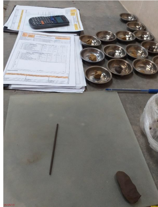
FOTO 12: Ensayo de Límites de Consistencia, ingresando al horno para obtener datos del peso seco.
