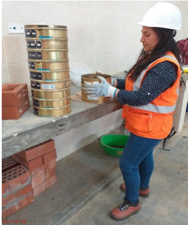
FOTO 11: Ensayo granulométrico por tamizado.
