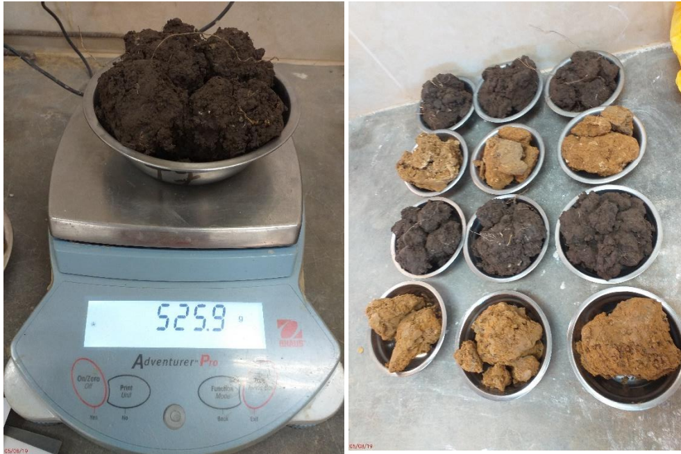
FOTO 8: Muestras para contenido de humedad.
