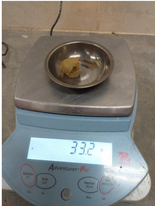
FOTO 12: Ensayo de Límites de Consistencia, ingresando al horno para obtener datos del peso seco.
