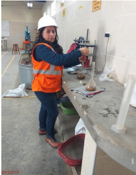
FOTO 14: Ensayo de Peso específico.
