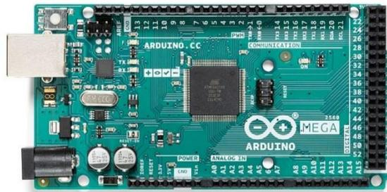
Figura 4: Placa Arduino Mega. (Arduino, 2021)
