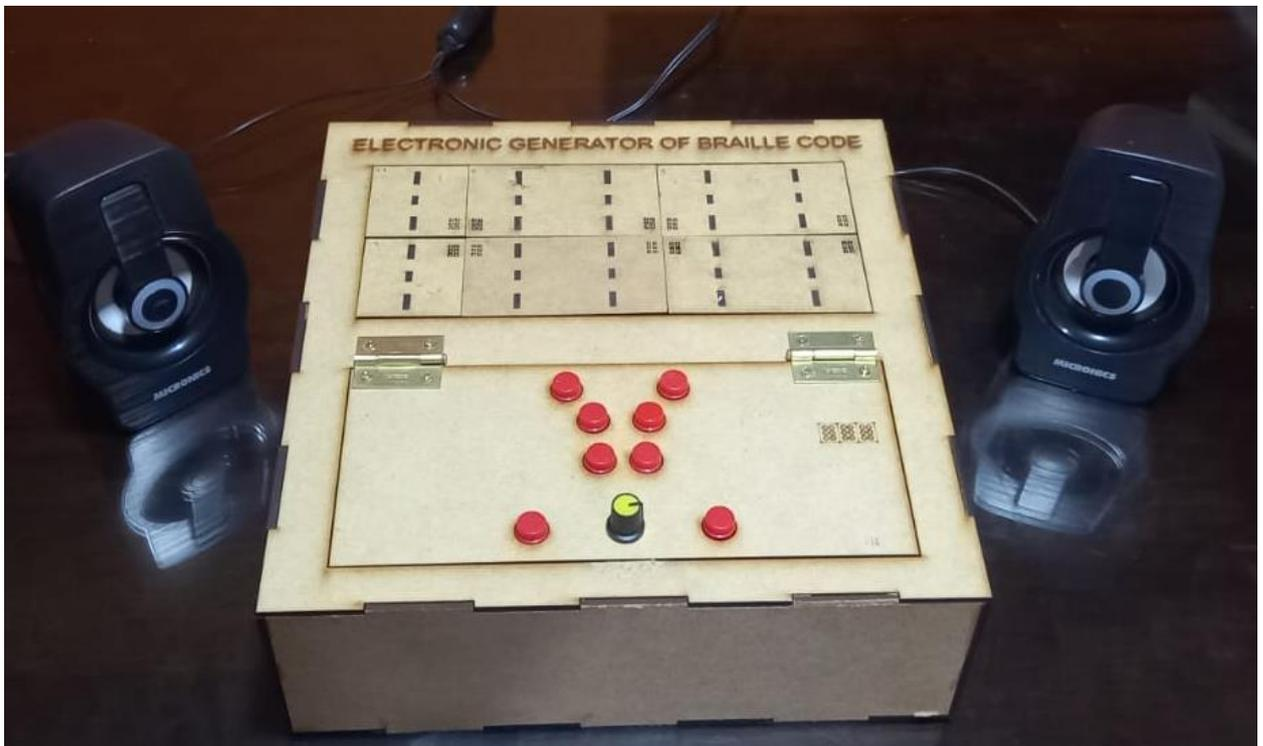
*Figura 32: Generador electrónico de código Braille*
