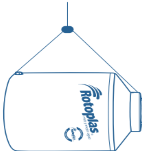
Figura N 3: Elevación del tanque a la azotea
