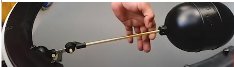
Figura N 47: "Fijación de la boya a 45°"
