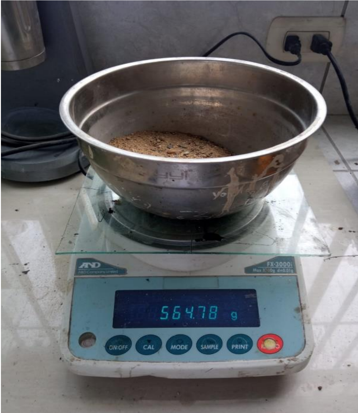
Anexo II-6: Pesado del Agregado Fino.
