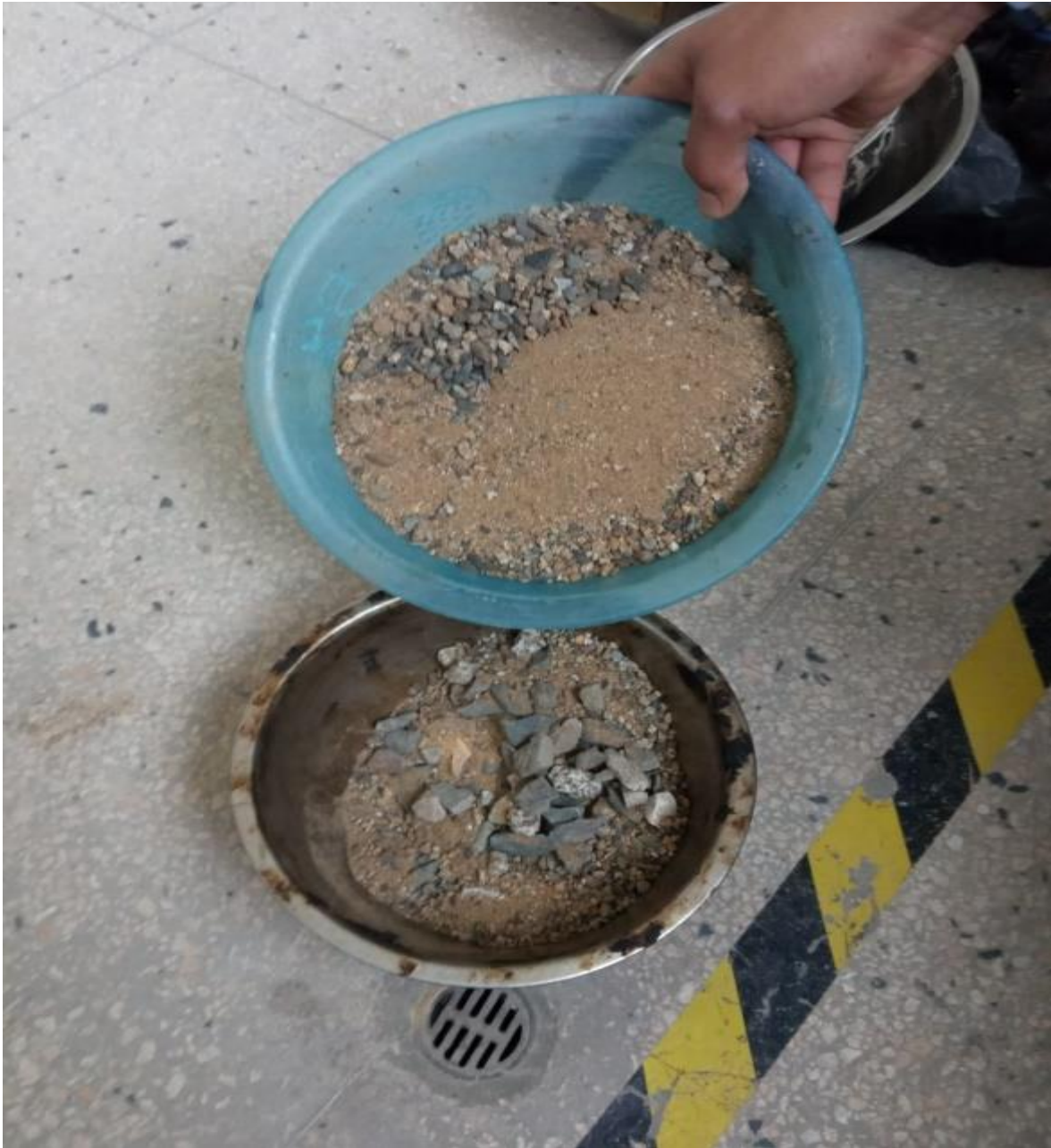
Anexo II-8: Proceso de mezclado de los Agregados.
