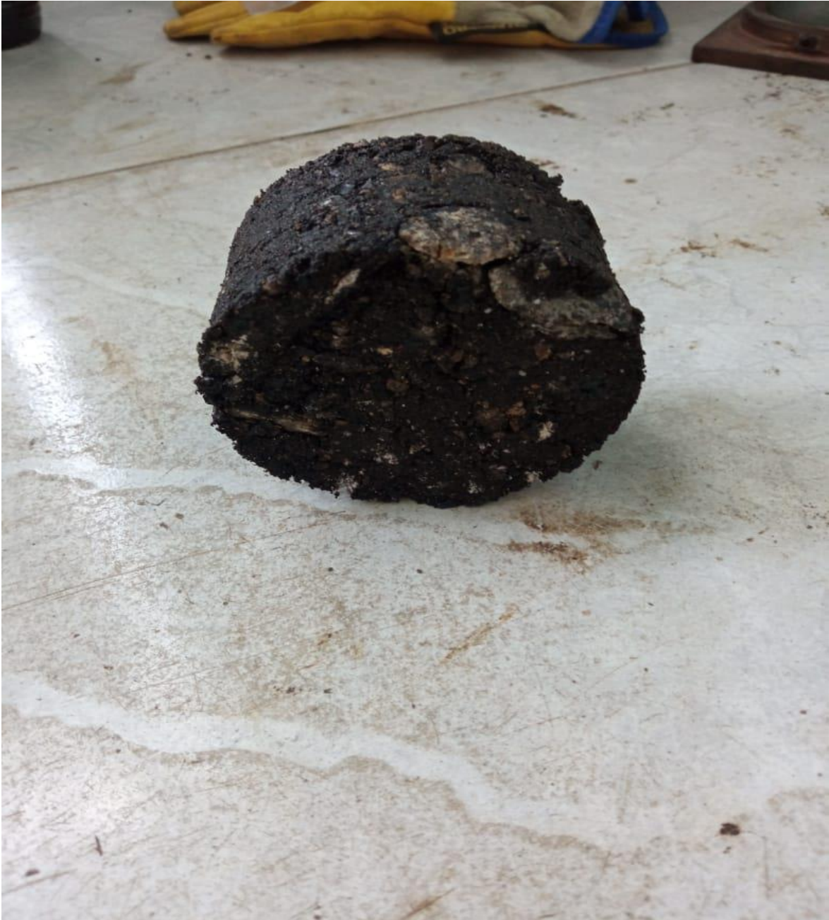
Anexo II-20: Briquetas después de estar en la prensa Marshall.
