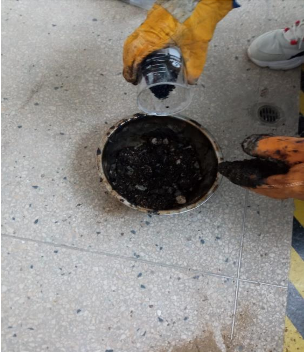
Anexo II-11: Proceso del Mezclado de los Agregados y la Mezcla Asfáltica.
