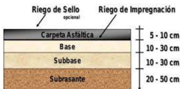
figura 1: Partes de un pavimento Flexible
