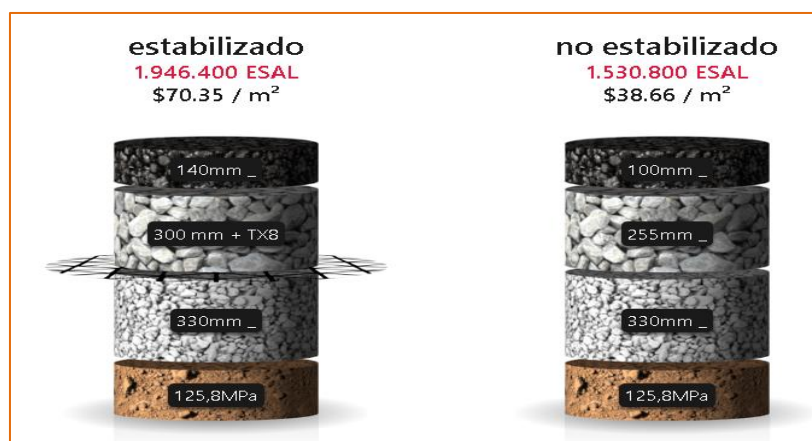
figura 9: Pavimento flexible con y sin geomalla con ESAL de diseño
