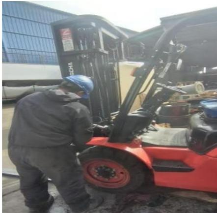
*Nota:* Con una bomba neumática es colocada la grasa en el equipo, el punto de conexión hembra abastece a la conexión del macho se realiza cada 500 horas.
