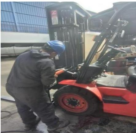
*Nota:* Para la inspección de los cilindros se realiza pruebas de carga y una inspección visual del pase del retén, esto es cada 500 horas.
