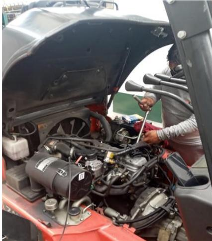
*Nota:* El cambio del filtro de combustible se realiza por la parte interna del motor cada 250 horas de trabajo, es imprescindible que se realice para que evite el ingreso del polvo al motor y dañe los cilindros.
