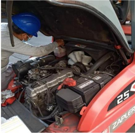
*Nota:* El cambio de filtro de transmisión se realiza conjuntamente con el de aceite debido al tiempo y ubicación que se encuentra en la máquina.
