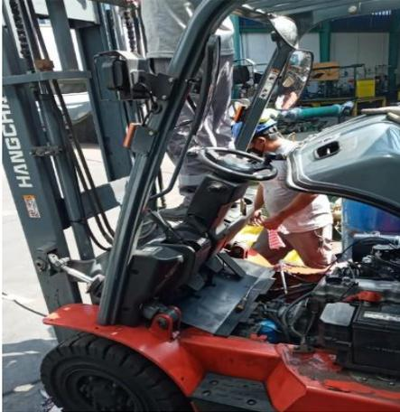
*Nota:* El mantenimiento se realiza en la fijación de pernos, abrazaderas y complemento general de toda la maquina cada 500 horas de recorrido.
