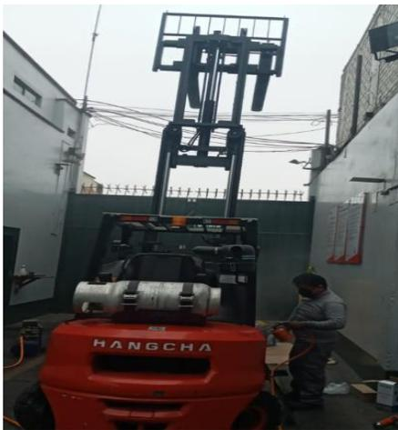
*Nota:* La revisión es midiendo la distancia del desgaste generado de polea a cadenas eso se realiza cada 500 horas
