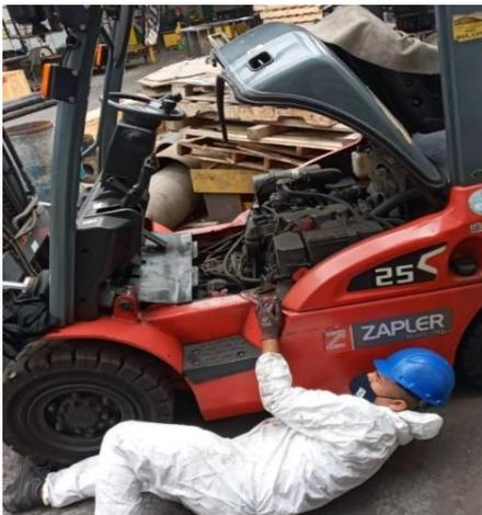
*Nota:* Para la revisión del refrigerante se destapa el asiento del montacarga y se procede a revisar el motor el cual cuenta con un marcador de niveles el nivel indica el estado actual de la maquinada para proceder a su cambio cada 500 horas.
