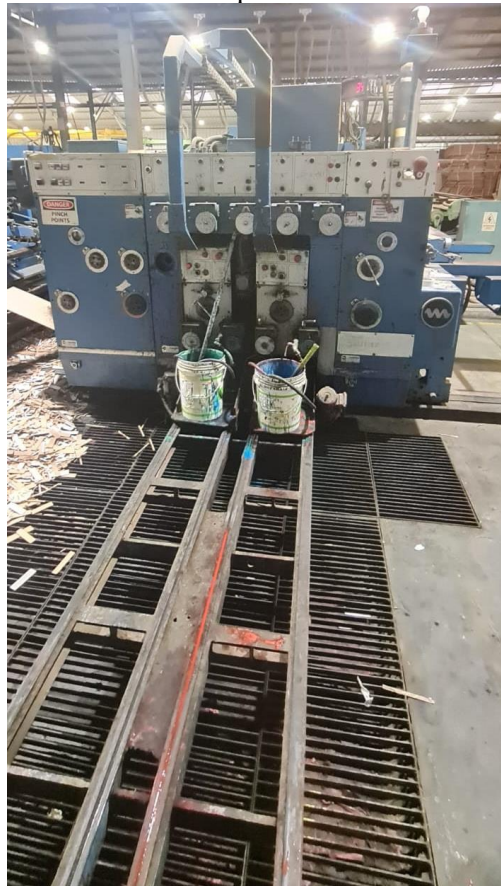
Ilustración 14 Zona de ingreso de tintas de la maquina Martin 924 de la empresa huayruro investments
