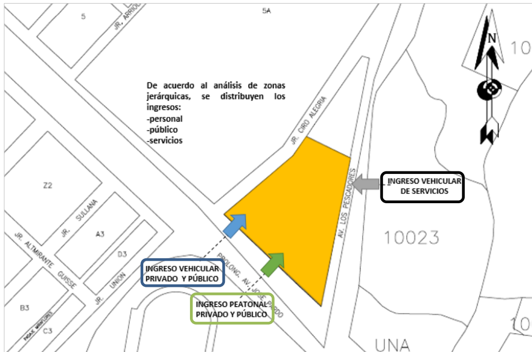
Figura n° 27: Análisis de accesos peatonales y vehiculares
