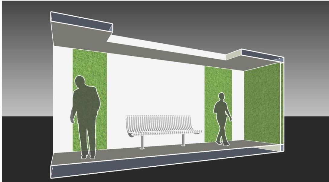
Figura n° 15: Empleo de claraboyas logrando iluminar al interior del espacio. Además de integrar muros verdes
