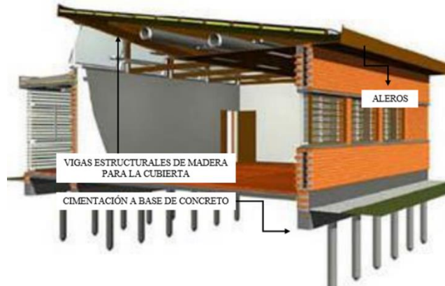
Figura 8. Estructuras y Detalles
