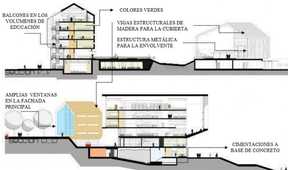
Figura 12. Estructuras y Detalles
