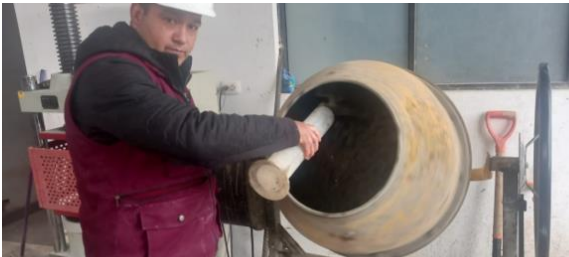
Agregando la mayólica triturada a la mezcla
