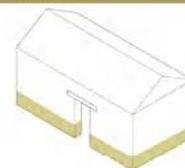
Se aprecian manchas de humedad (color oscurecido), que se inicia en la parte baja de los muros y puede alcanzar gran parte de la altura. Puede deteriorarse el enlucido y desprenderse la pintura. También puede mostrarse afloramiento de sales.
