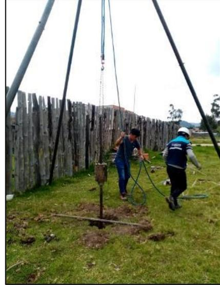
**Imagen N°14.** *Marcado de varilla cada 15cm y colocación de varilla en punto de sondeo*
