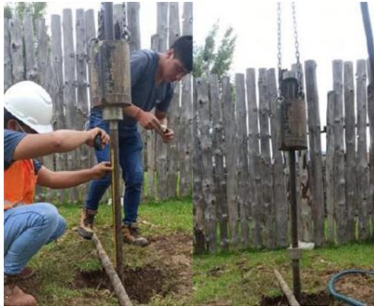
**Figura 12.** *Martillo empleado en la realización del SPT*
