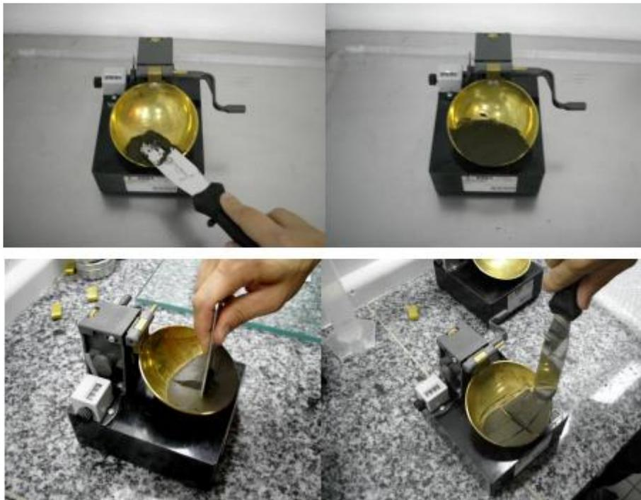
**Figura 5.** *Dispositivo mecánico del límite líquido*
