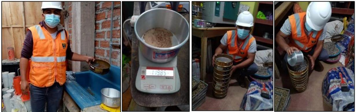
**Imagen N°20.** Análisis Granulométrico por tamizado
