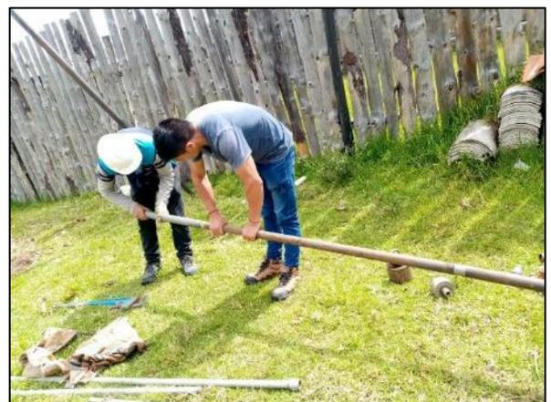
**Imagen N°13.** Colocación del muestreador en la varilla
