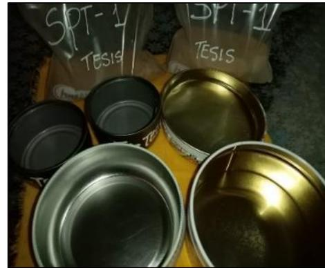
**Imagen N°19.** Muestra seca de ensayo SPT y codificación de taras para la realización de ensayos
