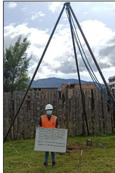
**Imagen N°17. Culminación del Ensayo de Penetración Estándar (SPT)**
