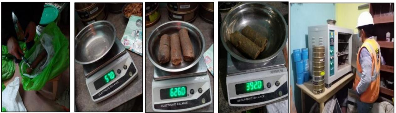
**Imagen N°18. Medición de diámetro de muestra con vernier, peso de tara + muestra y colocación a horno**
