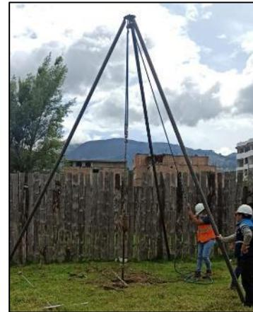
**Imagen N°15.** *Control de soga y conteo de golpes cada 15cm de marcación*
