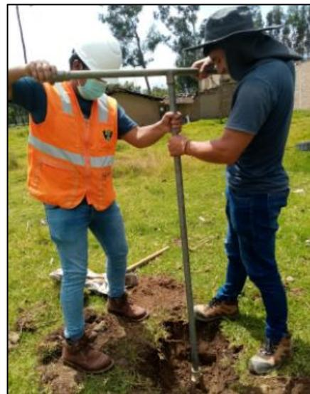
**Imagen N°11. Sondeo con posteador hasta profundidad requerida (3m)**
