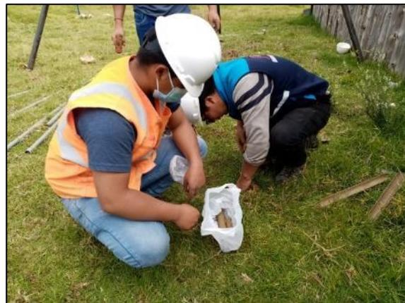
**Imagen N°16.** *Obtención de muestra de suelo para ser llevada a laboratorio para su estudio respectivo*
