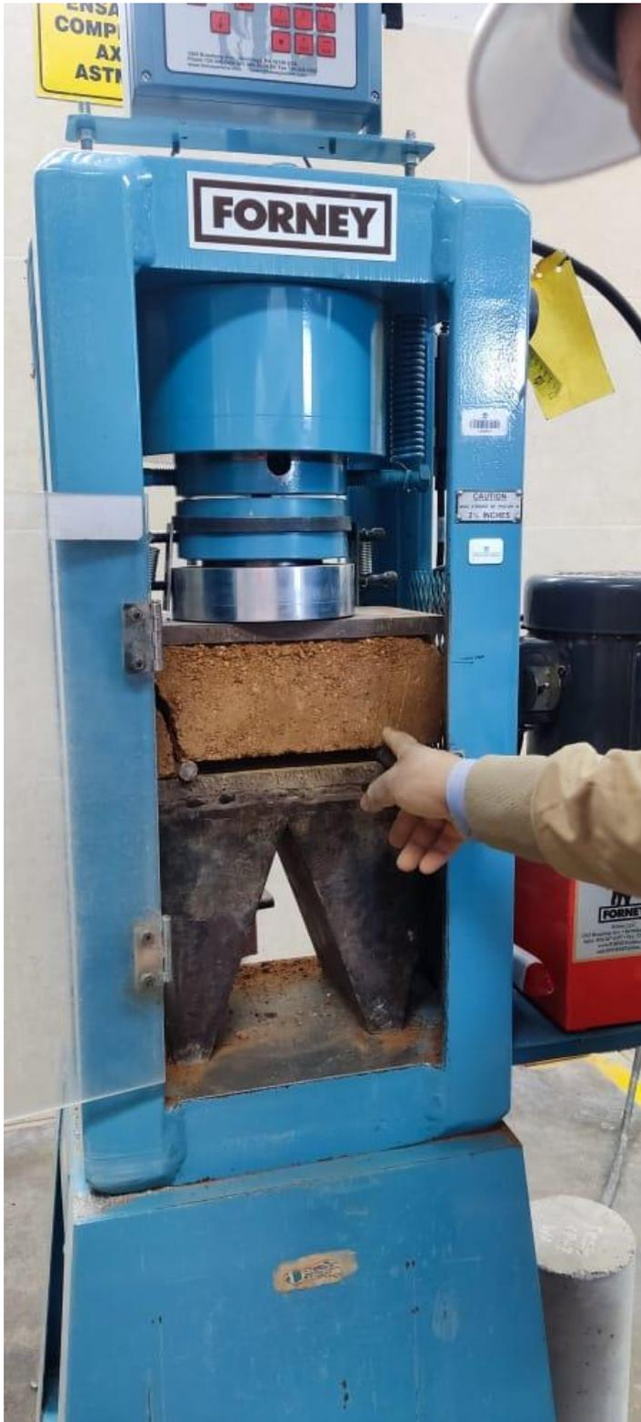
Fotografía 31. Ensayo de resistencia de los adobes compactados
