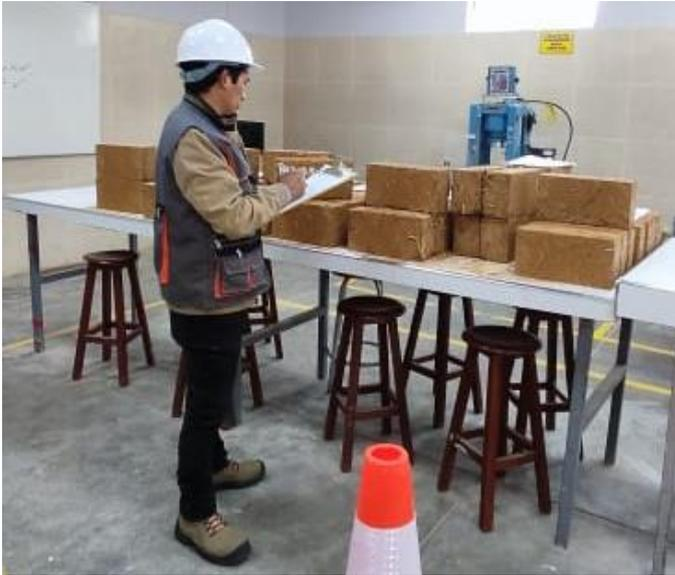
Fotografía 27. Medición de Adobes para determinar el área de la superficie de contacto de los ensayos a flexión
