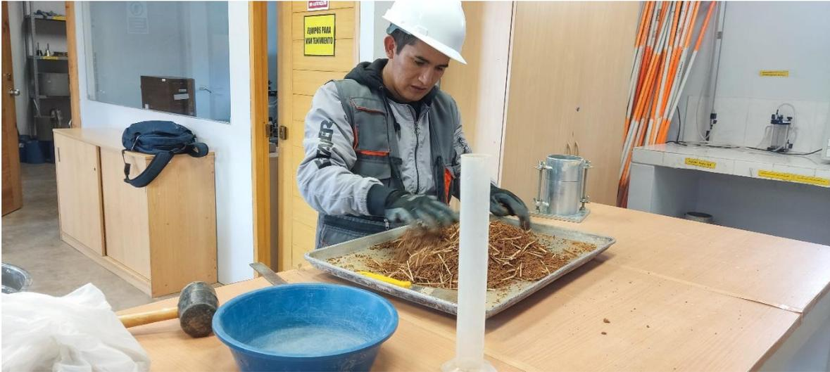
**Figura 15** Mezclado del Suelo con la Vaina de Bambú para el Ensayo de Compactación
