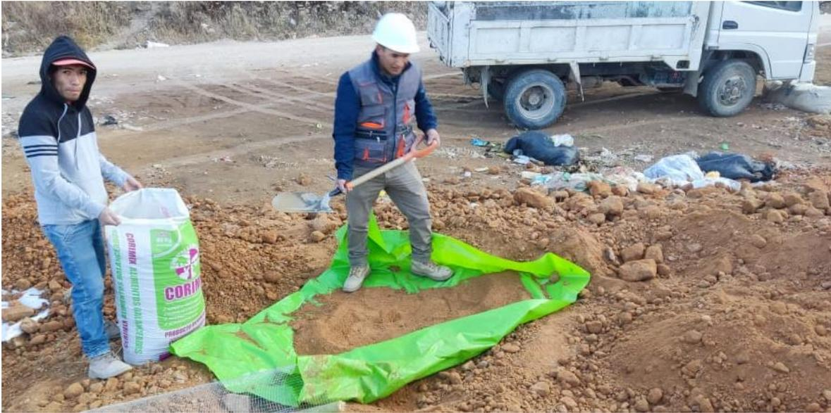
Fotografía 7. Proceso de recolección de suelo tamizado en sacos impermeables plastificados para conservar la humedad de la muestra
