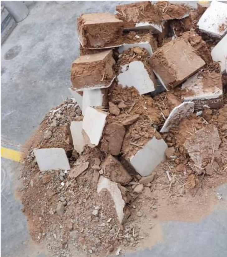
Fotografía 34. Adobes luego de los ensayos mecánicos
