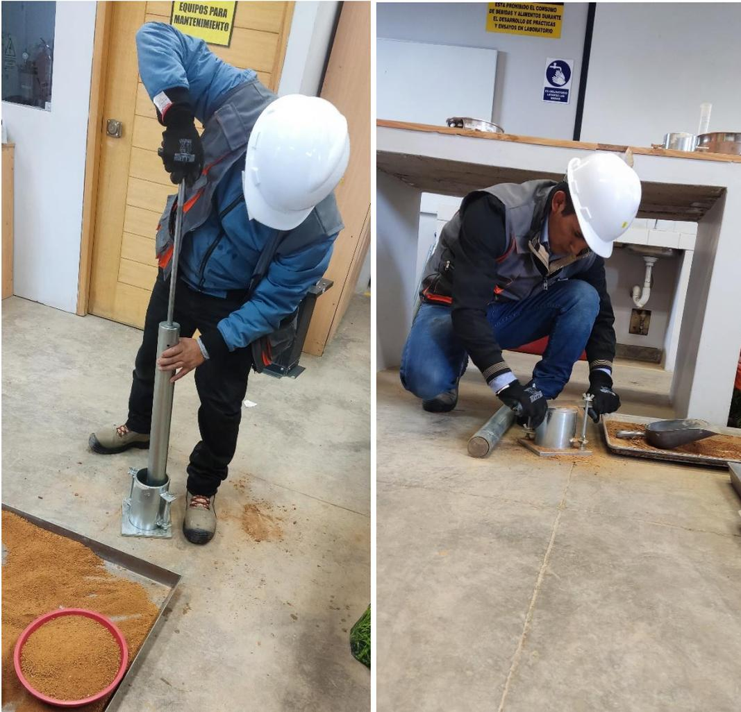
**Figura 10** Realización del Ensayo de Proctor Modificado
