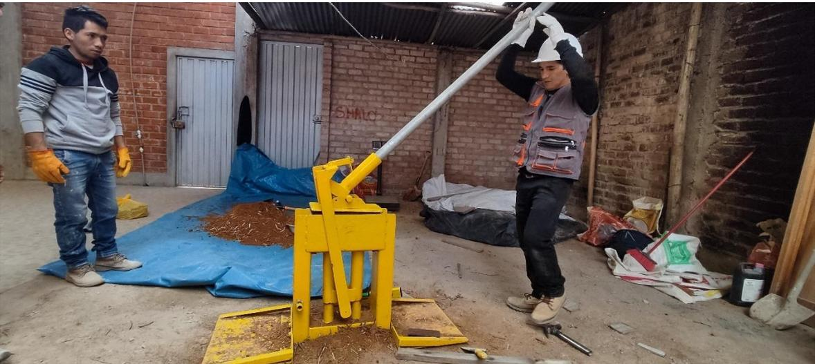
Fotografía 20. Aplicación de fuerza en la Máquina de Compactación - prensa CINVA-RAN para la elaboración de adobes compactados
