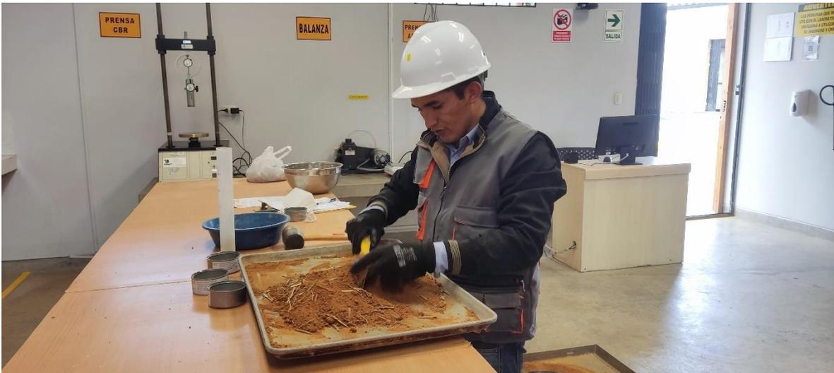
Fotografía 10. Combinación de la muestra de suelo con vaina de bambú para la realización del ensayo de Proctor modificado
