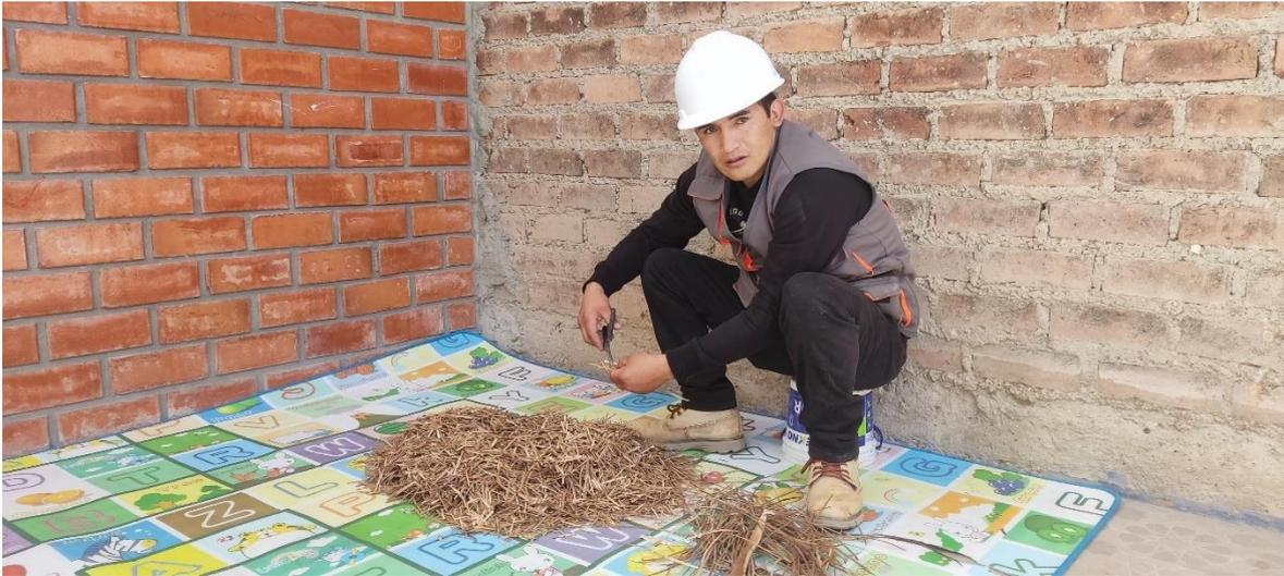
**Figura 14** Cortado de Vaina de Bambú en Fibras de 4, 5 y 6 cm
