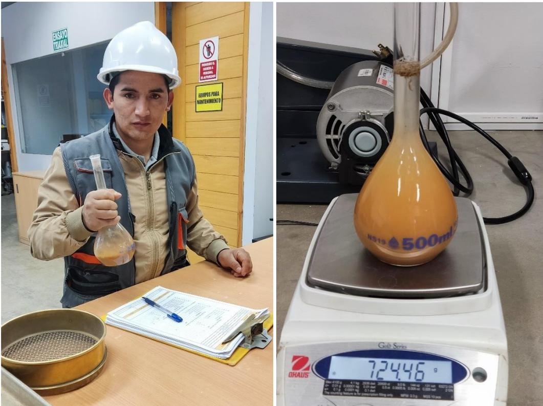
Fotografía 13. Ensayo de Peso Específico en el Suelo, (a) agitado de la muestra, (b) pesado del suelo.
