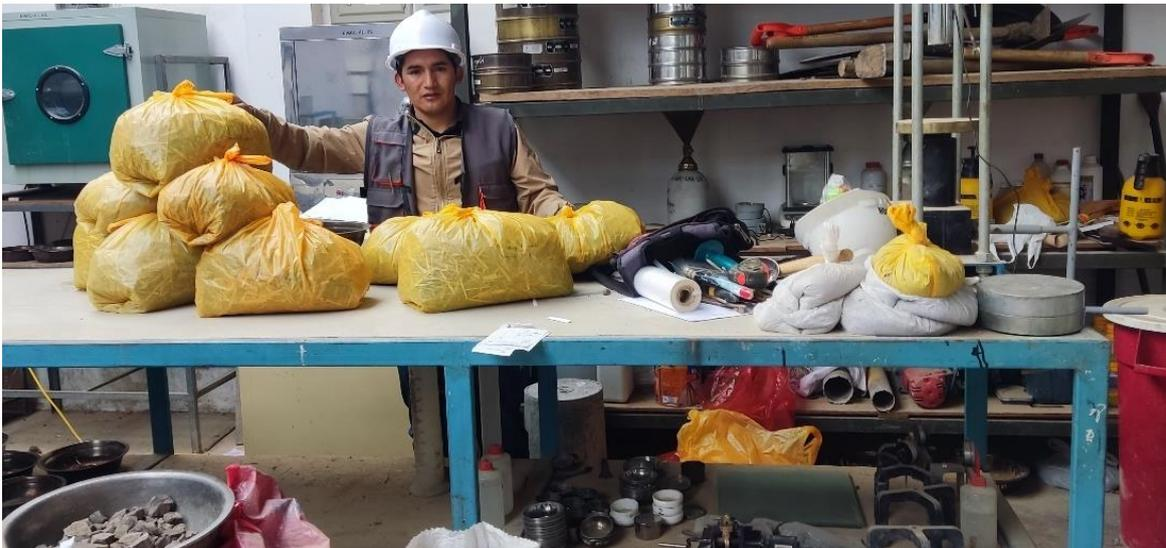
Fotografía 2. Pesado de la Fibras de Vaina de Bambú en bolsas para su uso en la elaboración de adobes compactados
