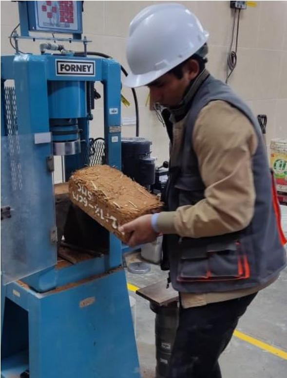
Fotografía 29. Colocación de Adobes en la Máquina para efectuar el ensayo a flexión
