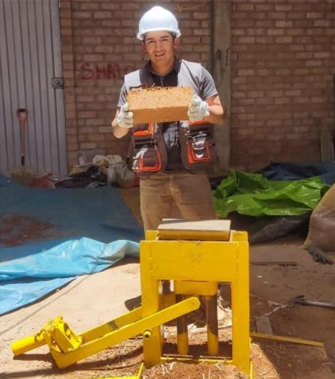
Fotografía 24. Adobes para Ensayo de Flexión elaborados en la prensa CINVA-RAN
