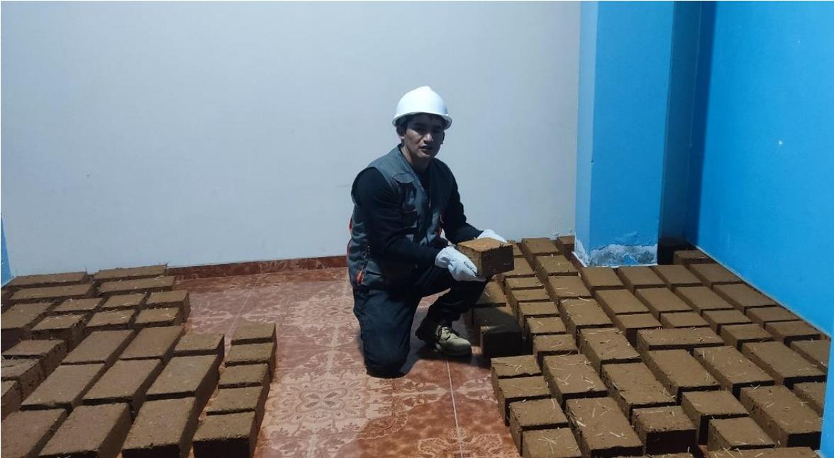
Fotografía 25. Secado de Adobes por 28 días previo a la realización de los ensayos de adobes compactados
