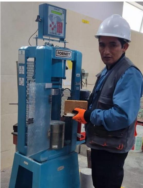
Fotografía 30. Colocación de los bloques para ensayos a compresión
