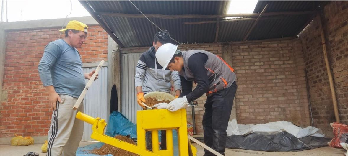
Fotografía 19. Colocación de la Mezcla de suelo con vaina de bambú en la Máquina de Compactación - prensa CINVA-RAN
