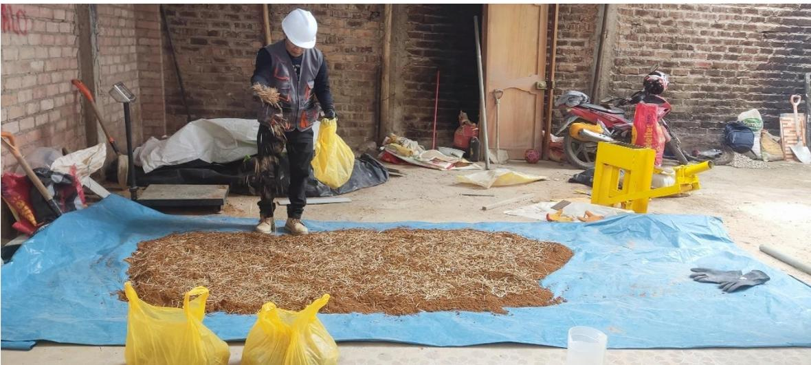
**Figura 17** *Adición de Fibras de Vaina de Bambú a la Tierra*
