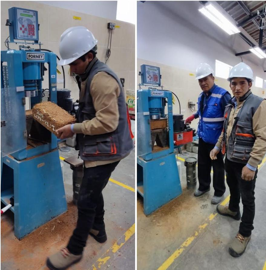
**Figura 21** *Ensayos Mecánicos en los Adobes con Vaina de Bambú*
