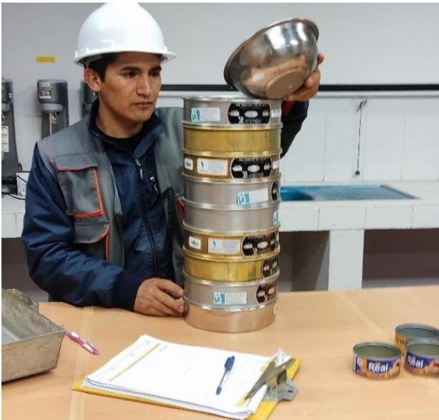
**Figura 8** Realización del Ensayo de Granulometría
