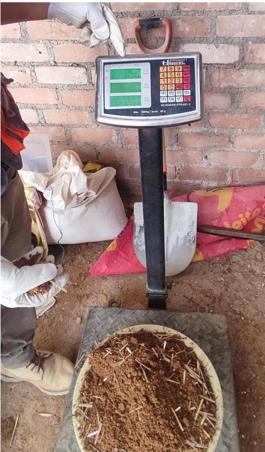
Fotografía 18. Pesado de suelo adicionando vaina de bambú en un total de 8.50 kg para la elaboración de 1 adobe
