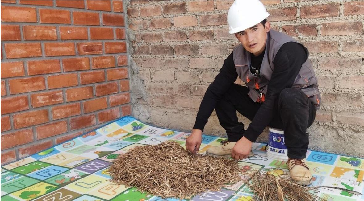
Fotografía 1. Cortado de las Fibras de Vaina de Bambú a 4 cm, 5 cm y 6 cm, utilizando herramientas manuales, como tijera y flexómetro
