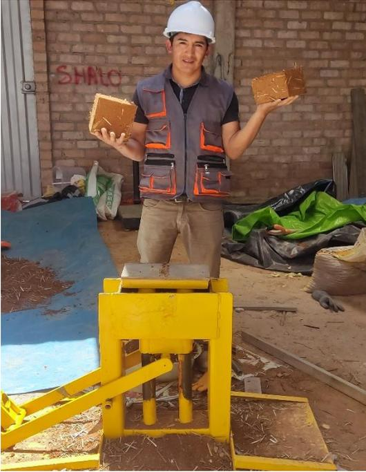
Fotografía 23. Adobes para Ensayo de Compresión elaborados en la prensa CINVA-RAN
