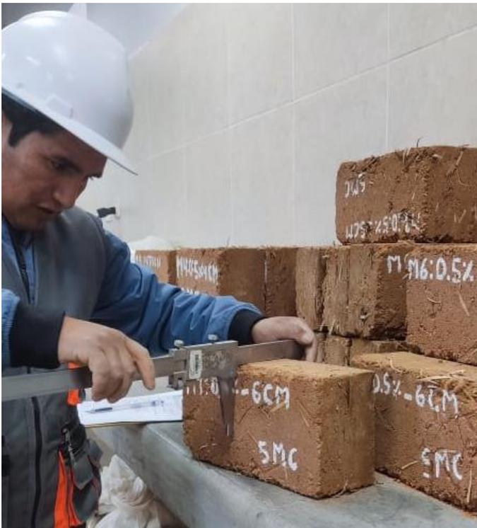
Fotografía 28. Medición de Adobes para determinar el área de la superficie de contacto de los ensayos a compresión
