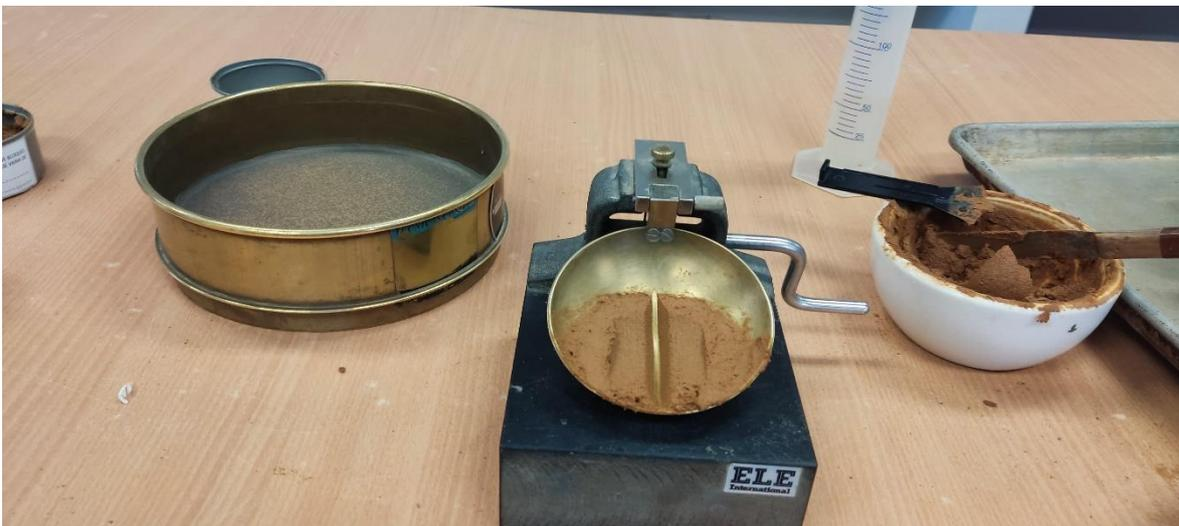
Fotografía 12. Ensayo de Límite Líquido en el Suelo, donde se puede observar la muestra homogénea en la copa casa grande, donde se ha separado el suelo con el ranurador
