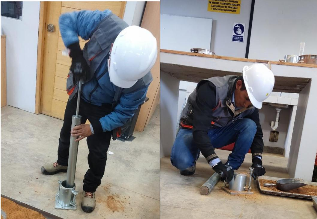
Fotografía 11. Ensayo de Proctor Modificado en el Suelo. (a) Compactación del suelo con 25 golpes en capas según el método A, (b) Enrasado de la muestra compactada para posterior pesado y secado en el horno.
