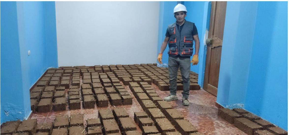
Fotografía 26. Vista de los adobes para Ensayo de Compresión y Flexión
