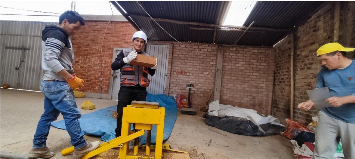
Fotografía 22. Sacado de Adobes Compactados de la Máquina prensa CINVA-RAN
