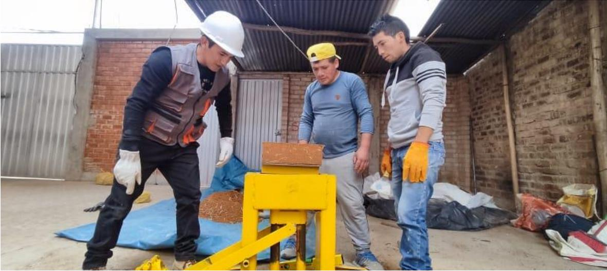
Fotografía 21. Visualización de adobes Elaborados en la Máquina de Compactación en la prensa CINVA-RAN
