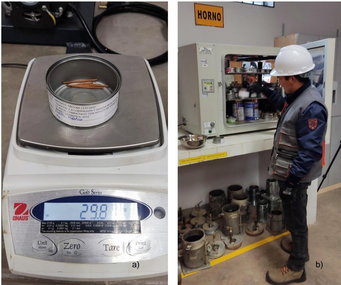
**Figura 7** Realización del Ensayo de Límite Plástico
