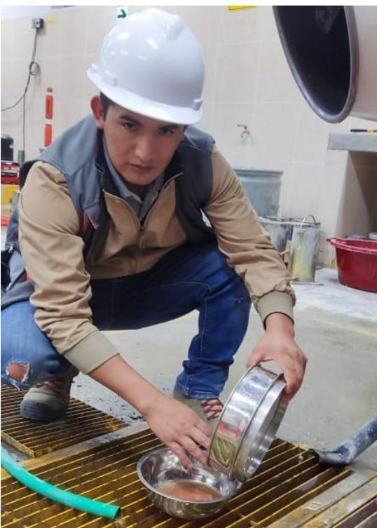
Fotografía 14. Lavado de muestra de suelo para ensayos de mecánica
