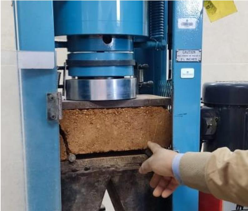
Fotografía 33. Muestra de rotura del adobe al aplicar las cargas
