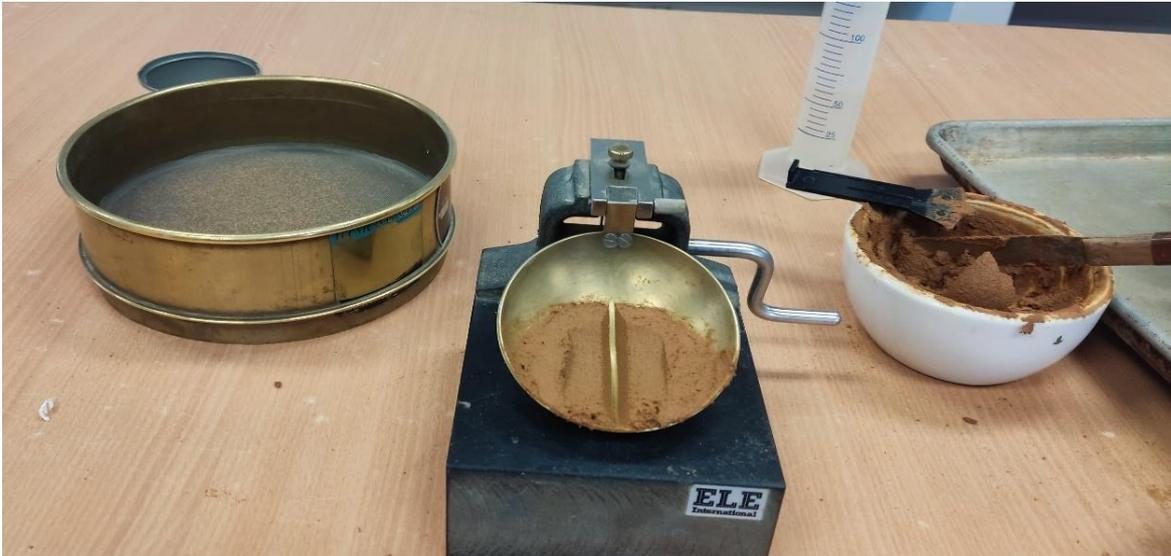
**Figura 6** Suelo para el Ensayo de Límite Líquido
