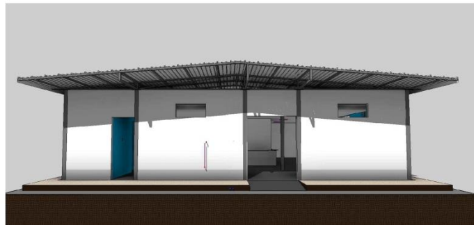
26. INSTALACION COBERTURA - CAIDA DOS AGUAS
