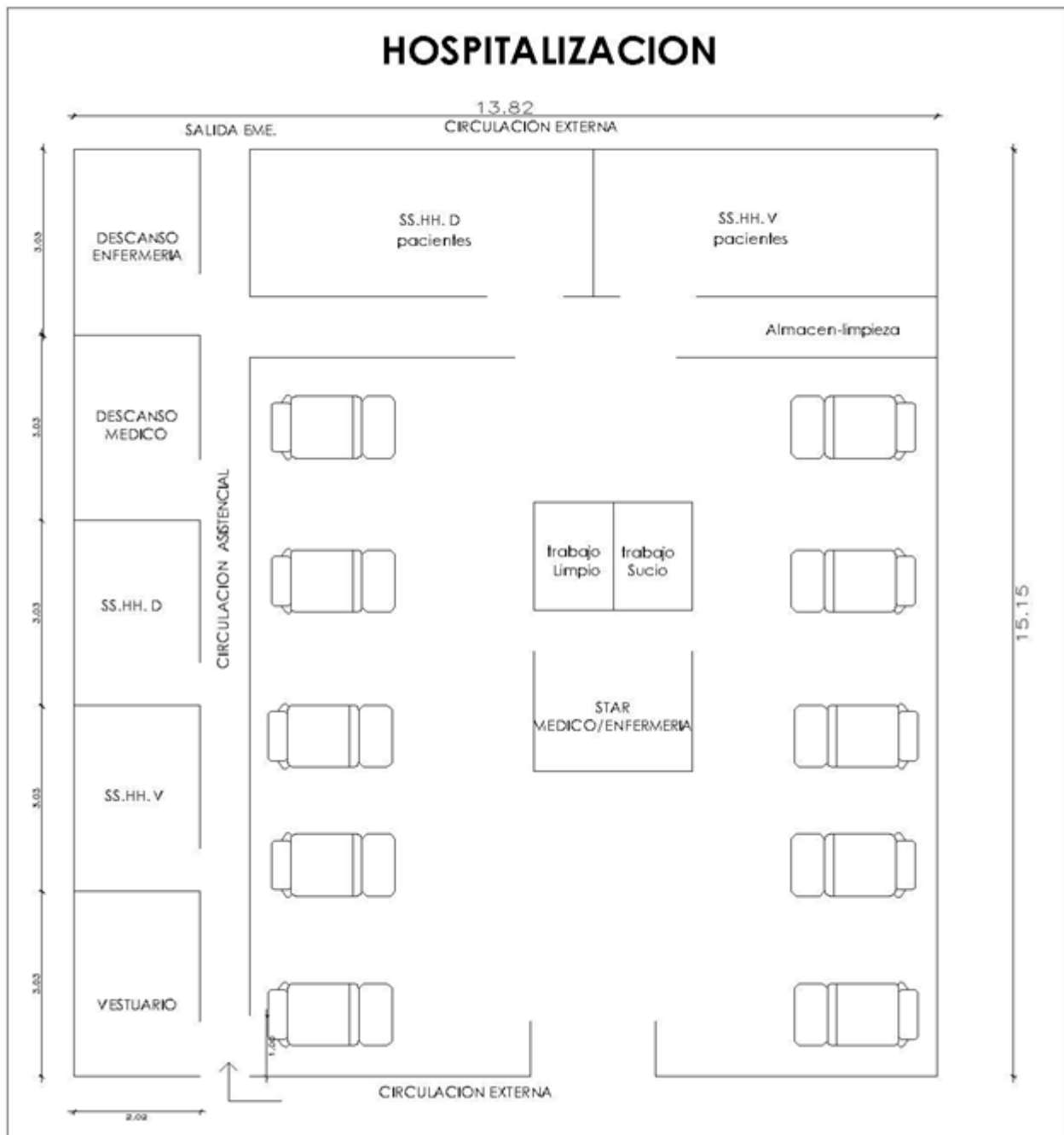
Figura N° 3-54: Replanteo de la distribución del módulo Hospitalización.
