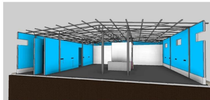
17. INSTALACION DE PLANCHAS DE YESO
