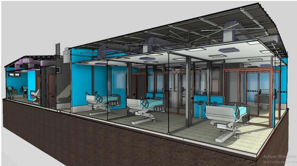
Figura N° 2-7: Construcción modular prefabricada de módulo UCI – Hospital de Huacho
