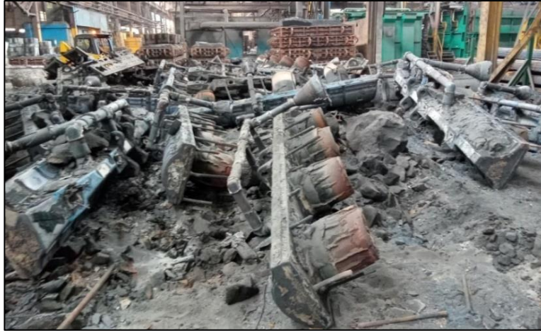
Figura 23. Proceso de Desmoldeo
