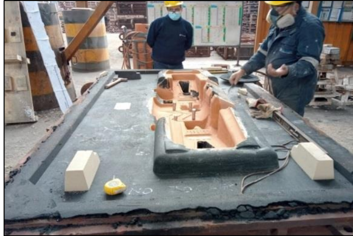
Figura 20. Proceso de moldeo.
