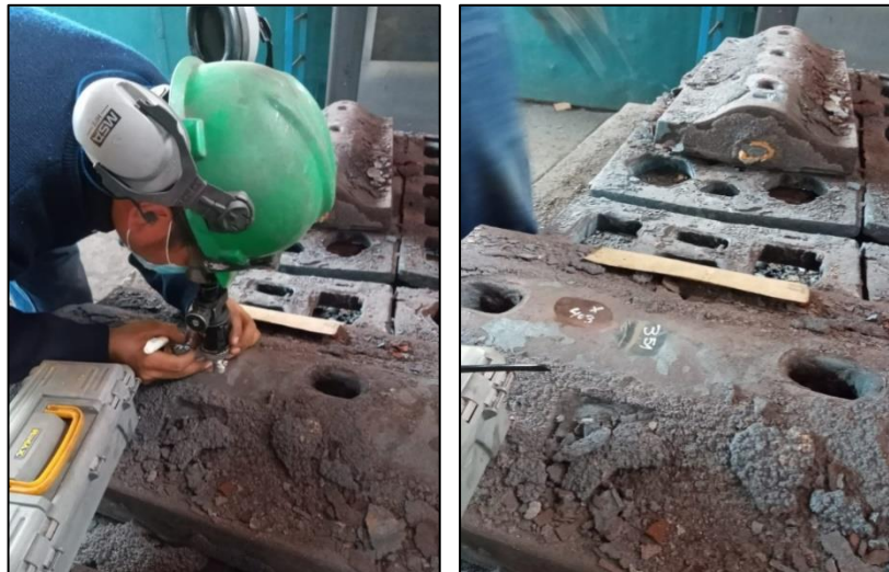
Figura 29. Proceso de toma de dureza.
