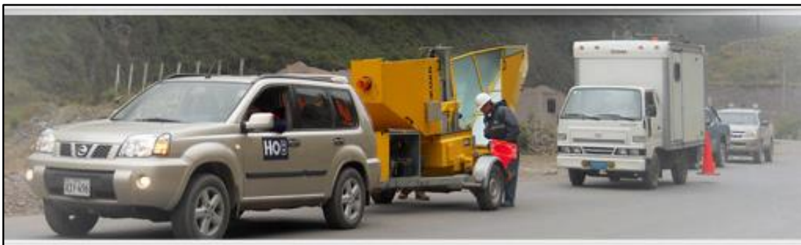
Figura N° 5 - Vista del Deflectometro Ligero antes de la evaluación
