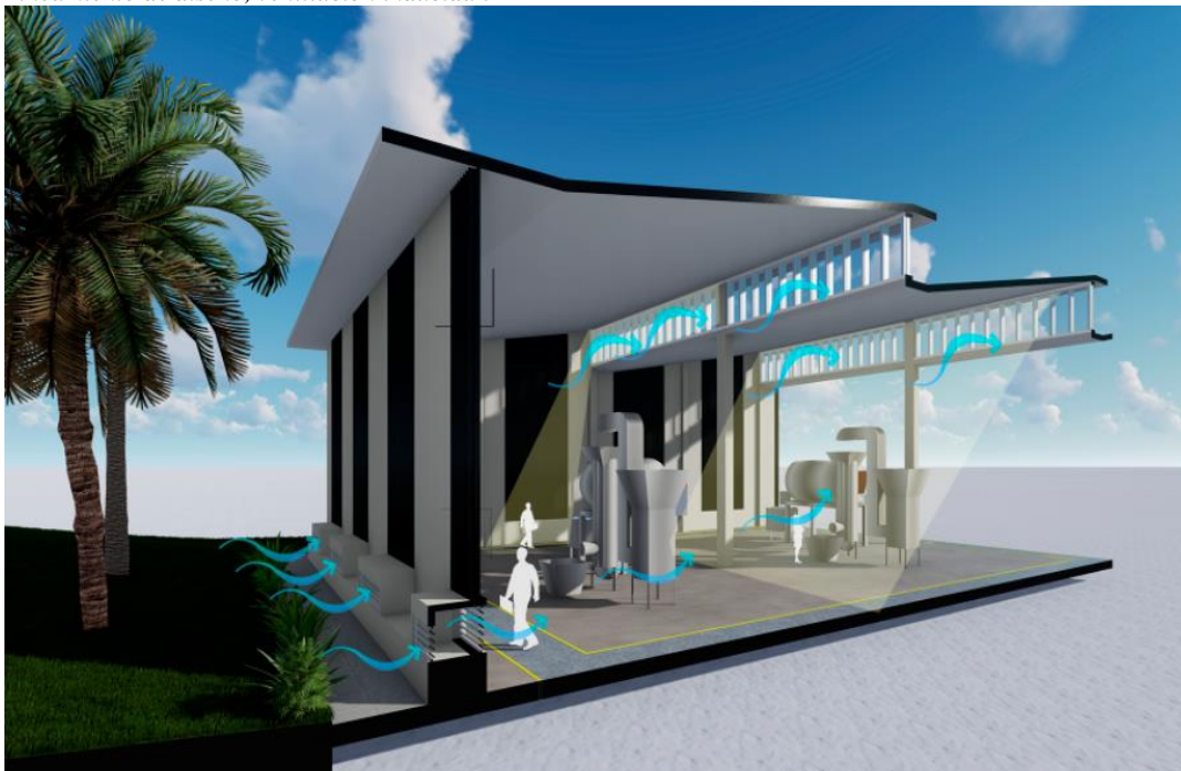
Figura N° 4. 15 Lineamiento de diseño, ventilación inducida 3D
