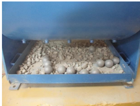
Fotografía 5: material luego de haber realizado el ensayo de abrasión.
