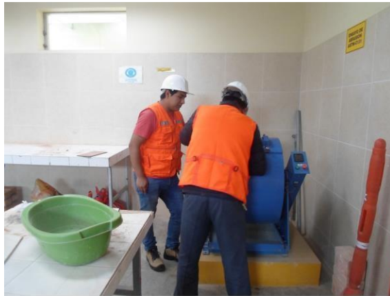
Fotografía 4: colocando material para realizar el ensayo de abrasión.
