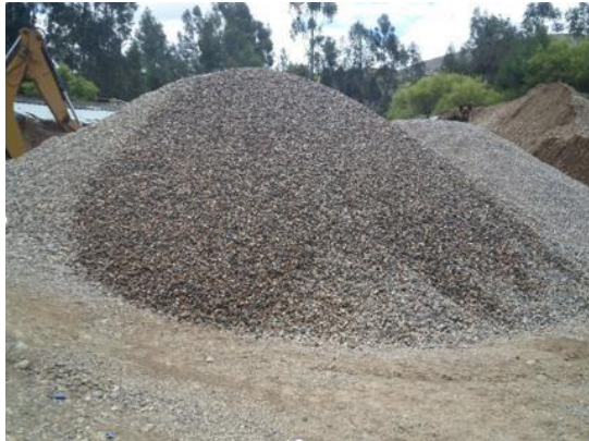
Fotografía 2: Agregado grueso cantera rio mashcon, Baños del Inca.
