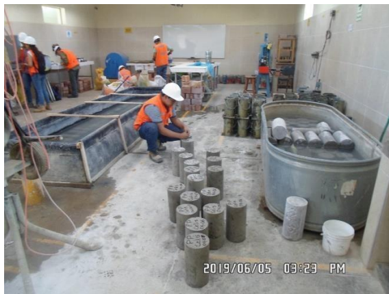
Fotografía 12: colocación de ID a cada una de las probetas ya desencofradas.
