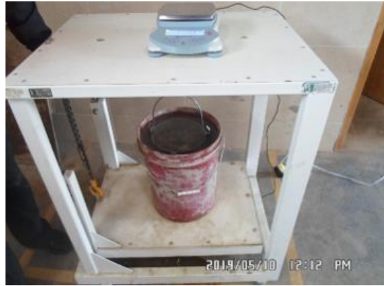
Fotografía 7: Ensayo de peso específico; agregado grueso dentro de la canastilla y sumergido bajo agua.
