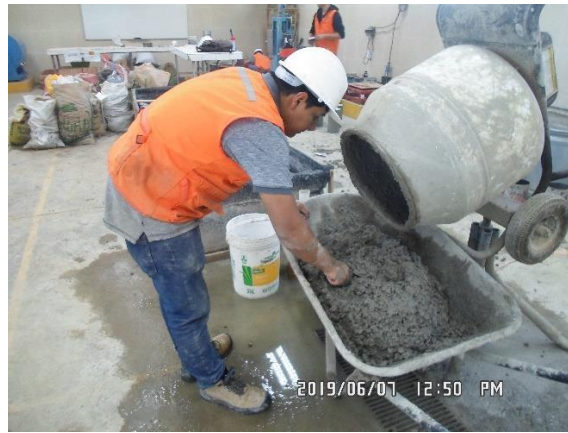
Fotografía 11: llenado de probetas de concreto.
