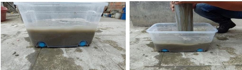
*Nota.* El acomodo del concreto por la tubería fue fluido, sin embargo, en los ensayos de caja en L y embudo en V no cumplió con los parámetros de un concreto autocompactable. Además, en el ensayo de cono invertido (trabajabilidad), no cumple con el tiempo de expansión.
