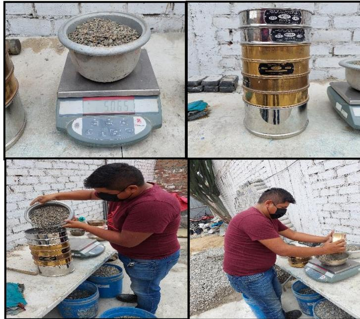
*Nota.* Análisis granulométrico del agregado grueso
