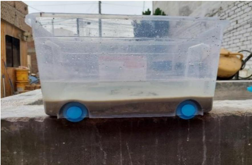
*Nota.* El acomodo del concreto por la tubería fue con mucha facilidad. Al contacto con el agua se observó un buen comportamiento, se mantuvo cohesiva y con viscosidad requerida. No presento segregación de los agregados. La mezcla por lo tanto el deslave fue mucho menos.
