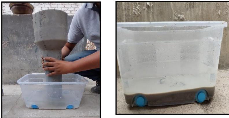
*Nota.* Colocación del concreto autocompactante mediante el método tremie
