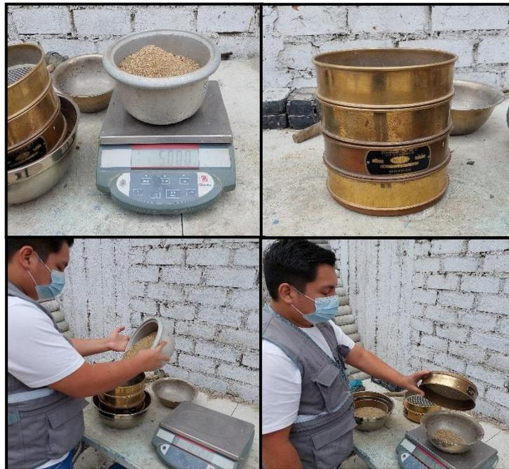
*Nota.* Análisis granulométrico del agregado fino
