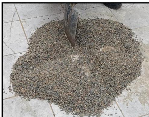
*Nota.* Homogenización y cuarto del agregado grueso
