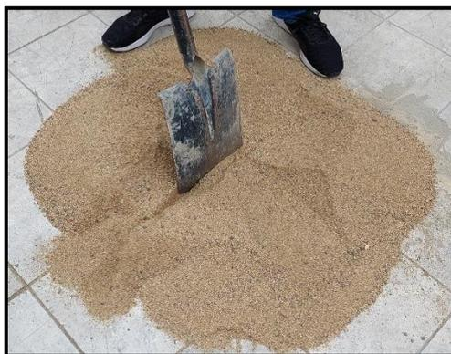
*Nota.* Homogenización y cuarto del agregado fino
