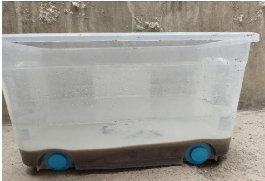
*Nota.* El acomodo del concreto por la tubería fue con mayor facilidad. Al contacto con el agua se observó un ligero lavado del cemento, pero la mezcla siempre se mantuvo cohesiva y con viscosidad requerida. No presentó segregación de los agregados.
