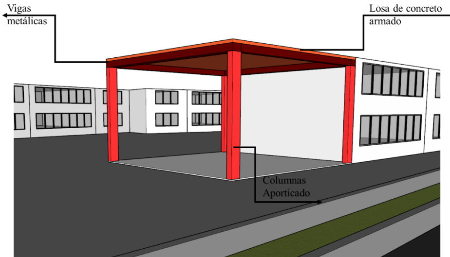
Figura 33. Gráfico de sistema estructural del Caso N°5.
