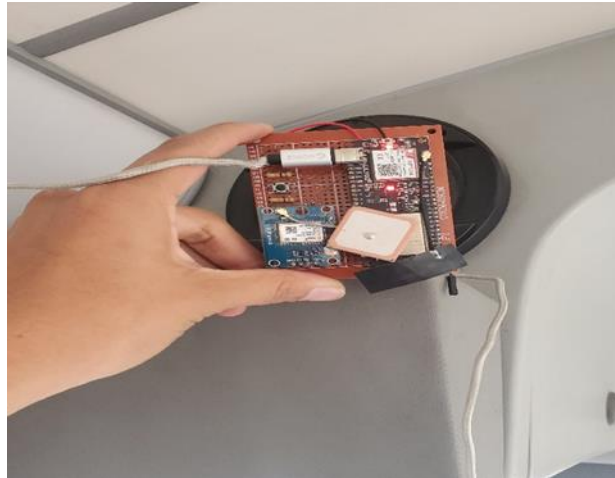
Figura XXVIII Conexión a la salida de voltaje de la radio del vehículo
