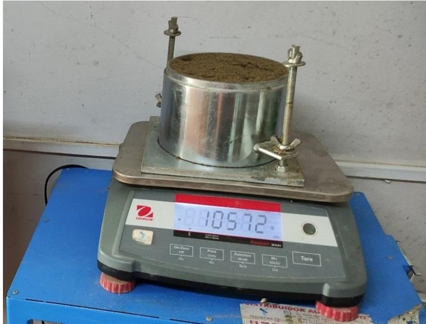
Figura 14 Ensayo de Proctor, suelo compactado para C-01
