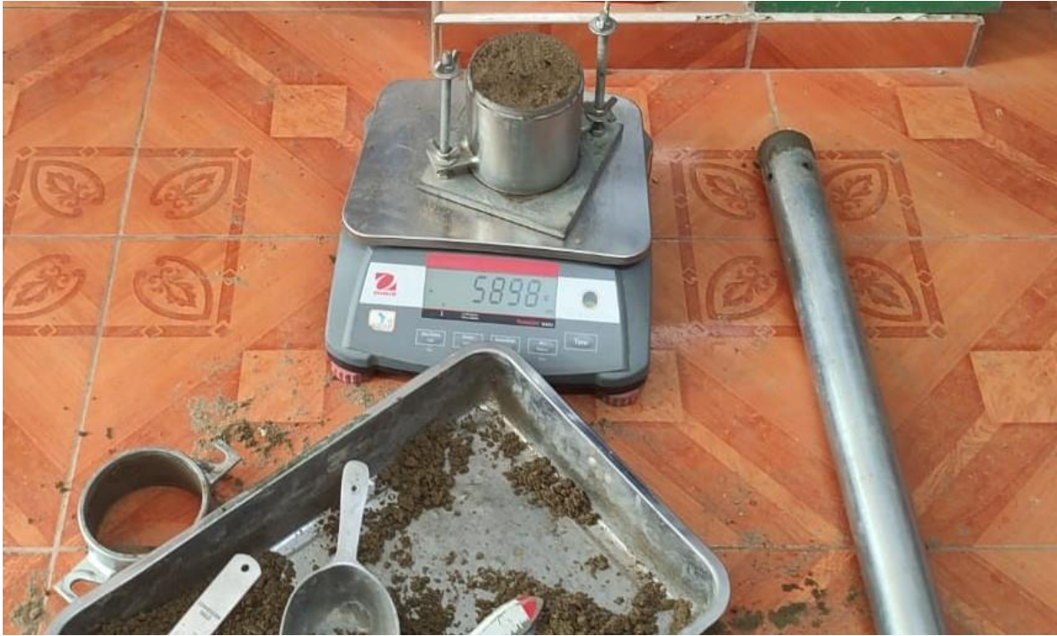
Figura 18 Ensayo de Proctor, suelo compactado para C-03
