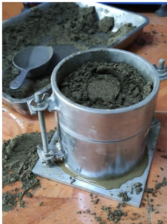
Figura 15 Ensayo de Proctor, suelo compactado saturado para C-01
