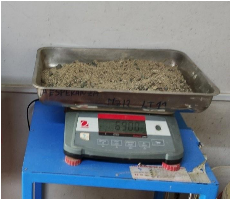
Figura 13 Ensayo de Proctor para C-01
