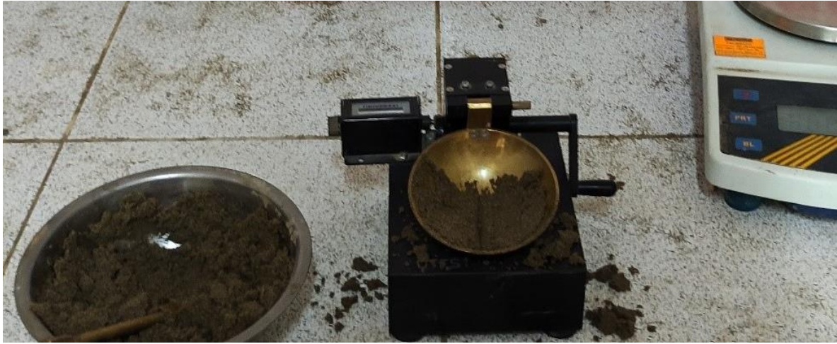
Figura 12 Ensayo de Límite Líquido para C-01
