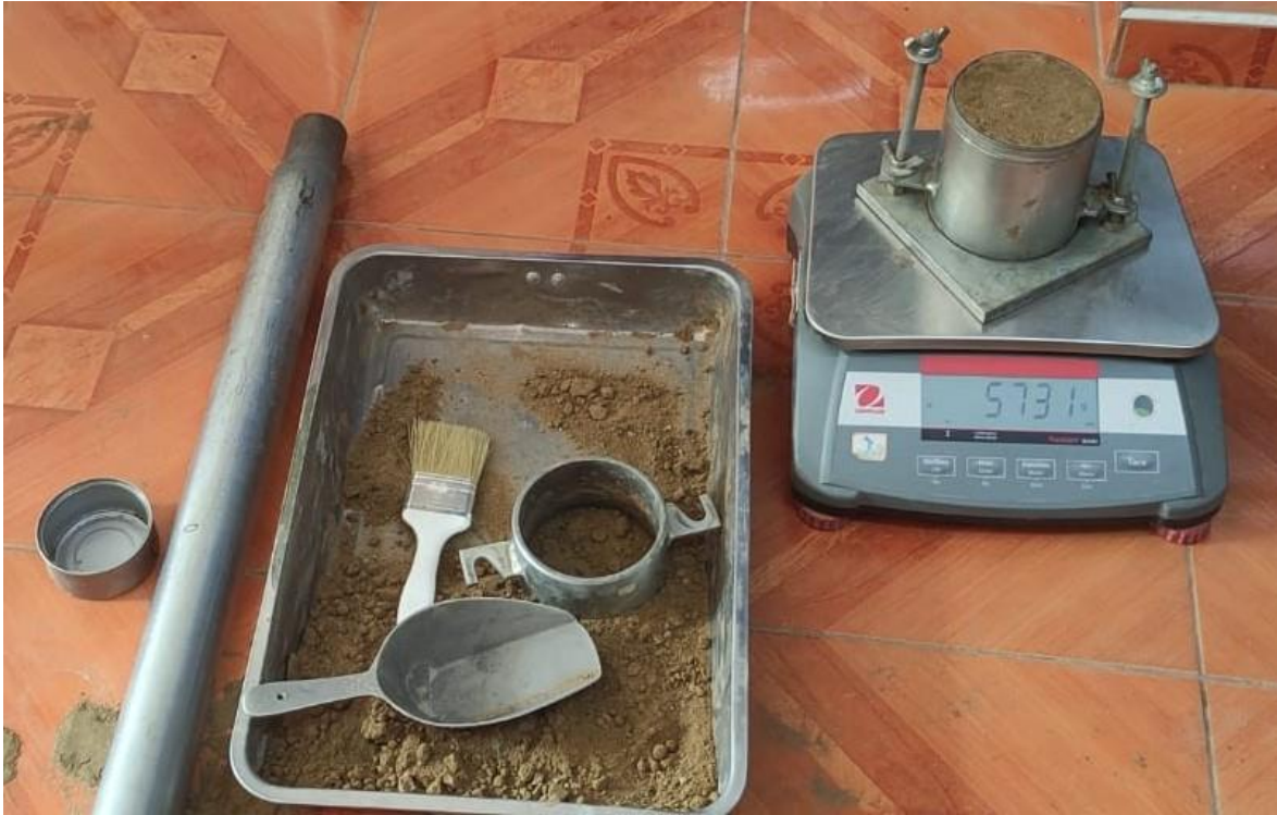
Figura 16 Ensayo de Proctor, suelo compactado para C-02
