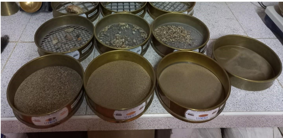
Figura 17 Ensayo de Granulometría, suelo compactado para C-03
