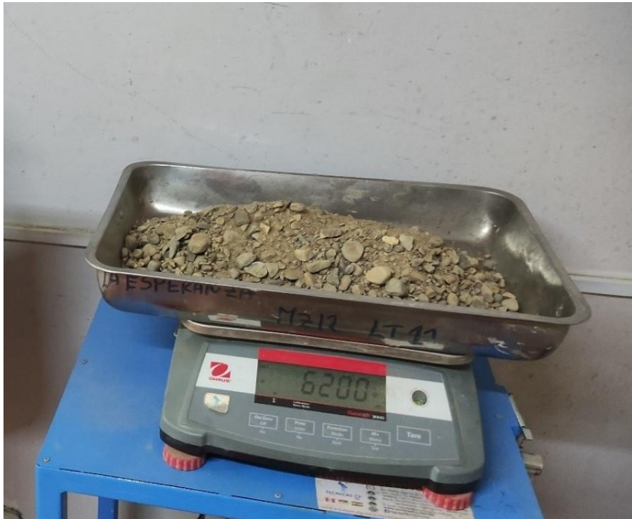
Figura 19 Muestra para Ensayo de Proctor, para C-04
