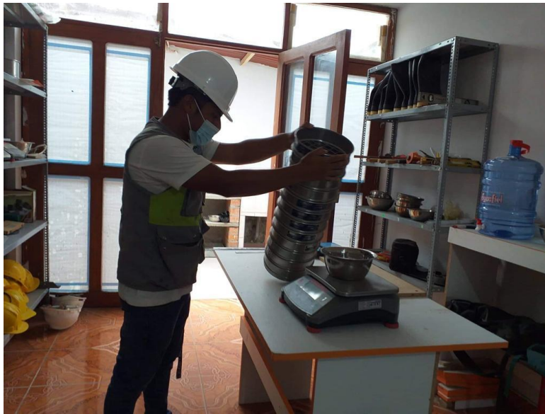
Ilustración 7. Analisis granulométrico del material extraído de la calicata
