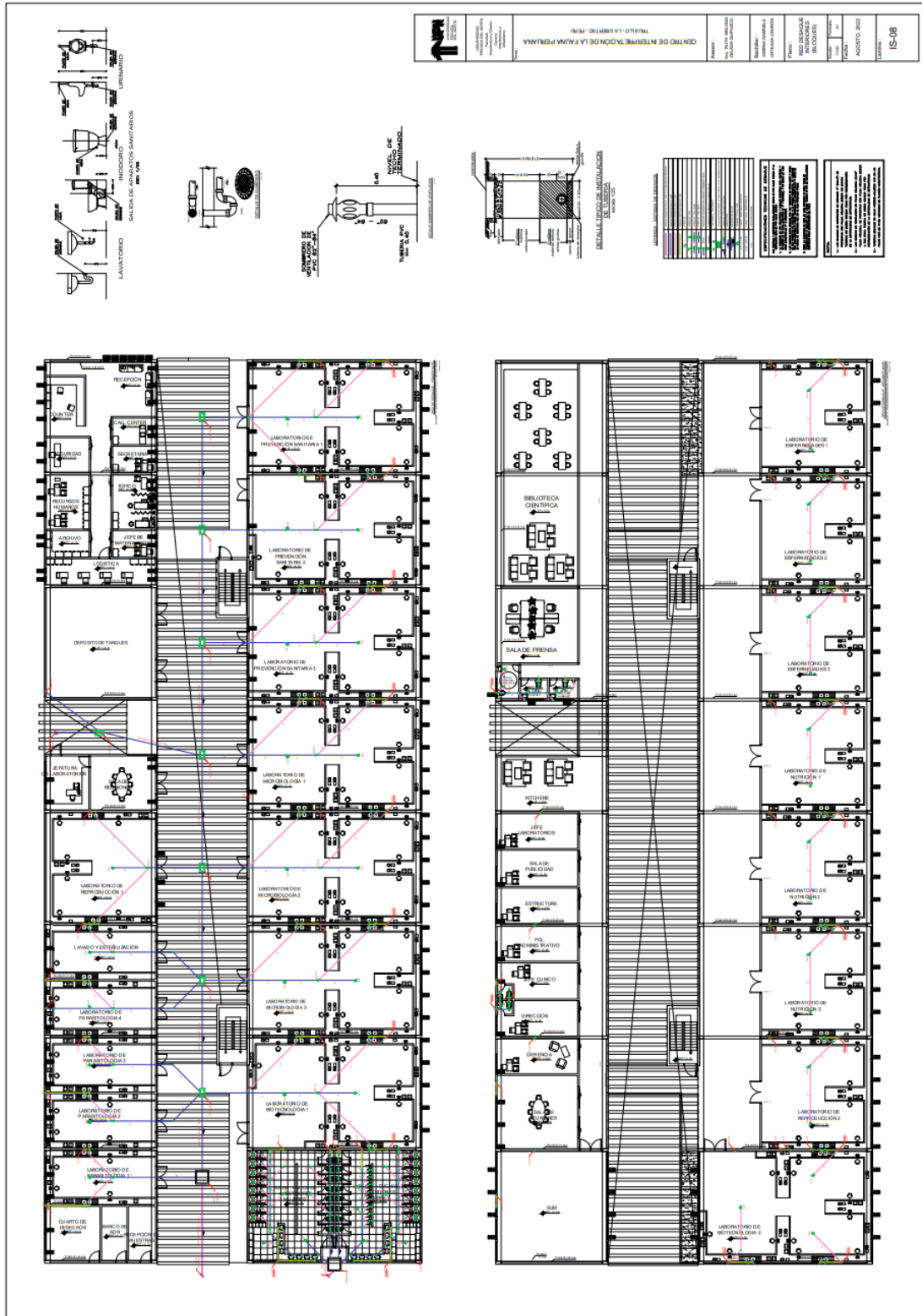
Figura 60. red de desagüe laboratorios.
