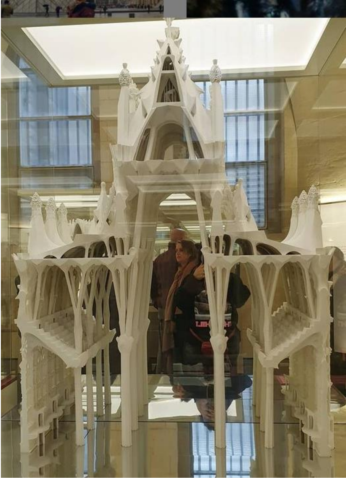
Figura 97. Modelado 3D de la estructura de la nave central y el área de coro a detalle, utilizado en la construcción actual como guía.
