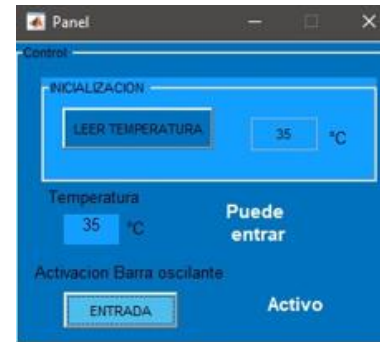
Fig. 3 Panel de control activo, cuando la temperatura es menos a 37,3°C.
