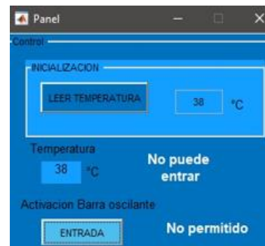
Fig. 4 Panel de control activo, cuando la temperatura es mayor a 37,3°C.
