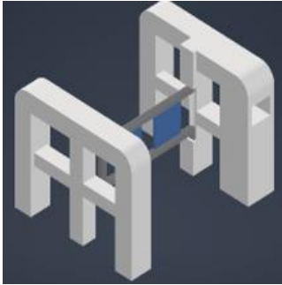
Fig. 5 Sistema mecánico cuando esta denegado el acceso.
