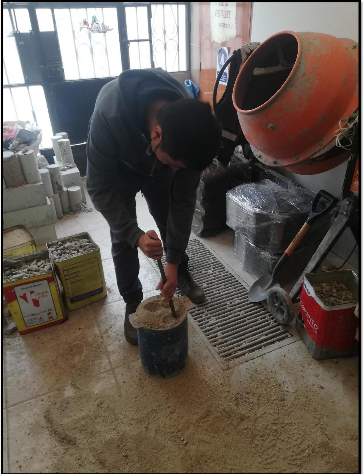
Anexo 20: Ensayo peso unitario compactado agregado fino (2)
