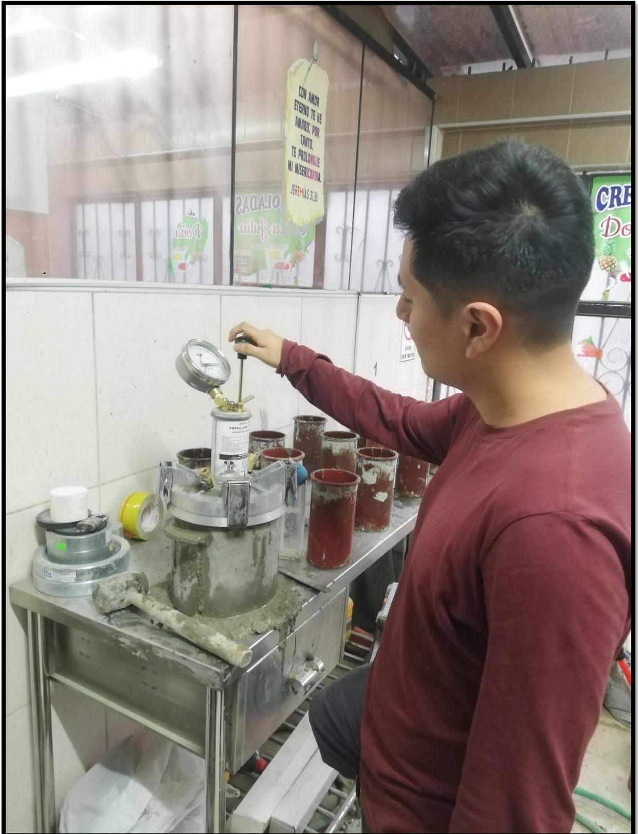
Anexo 50: Ensayo para determinar la temperatura del concreto en estado fresco
