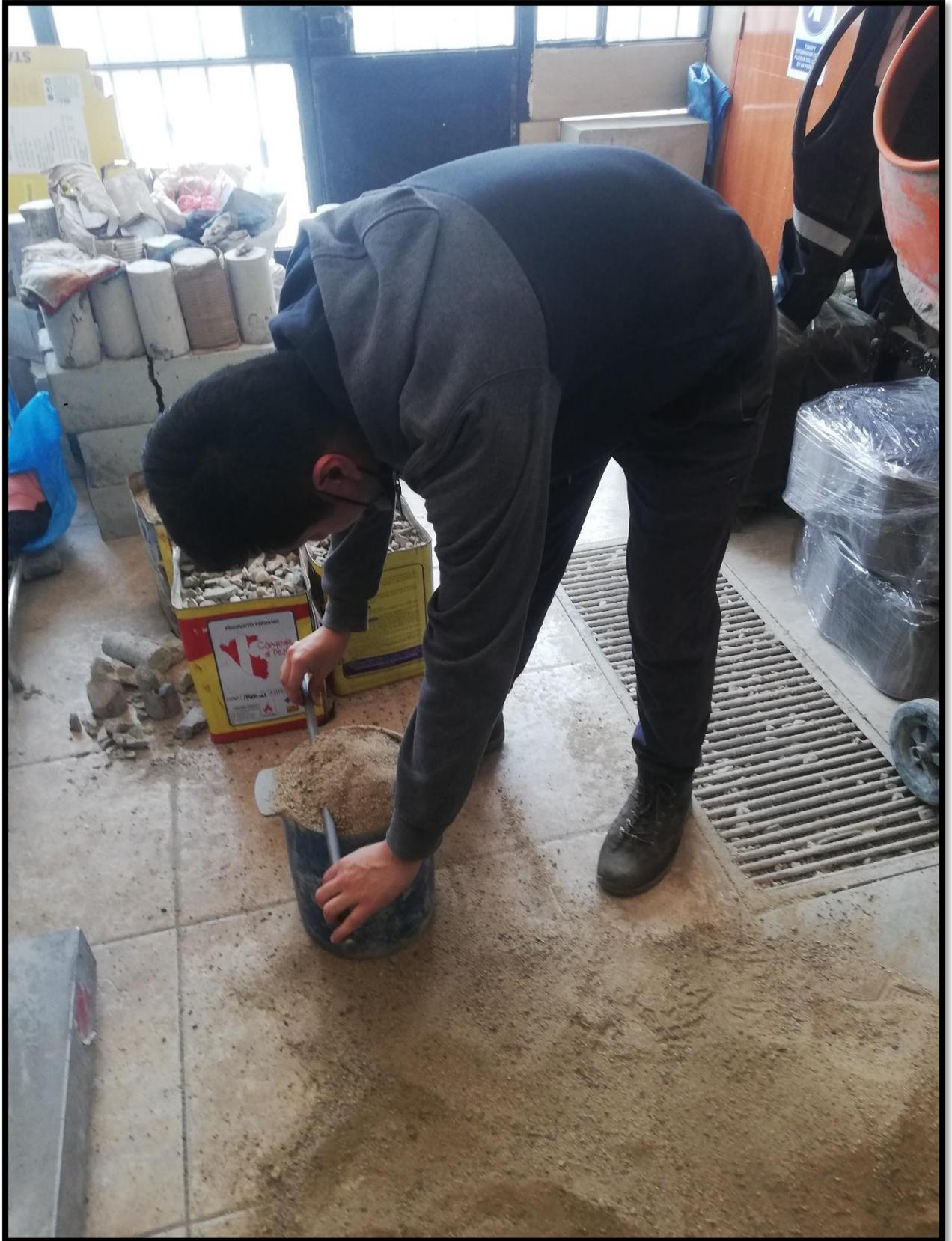
Anexo 21: Ensayo peso específico y absorción del agregado fino – Parte 1
