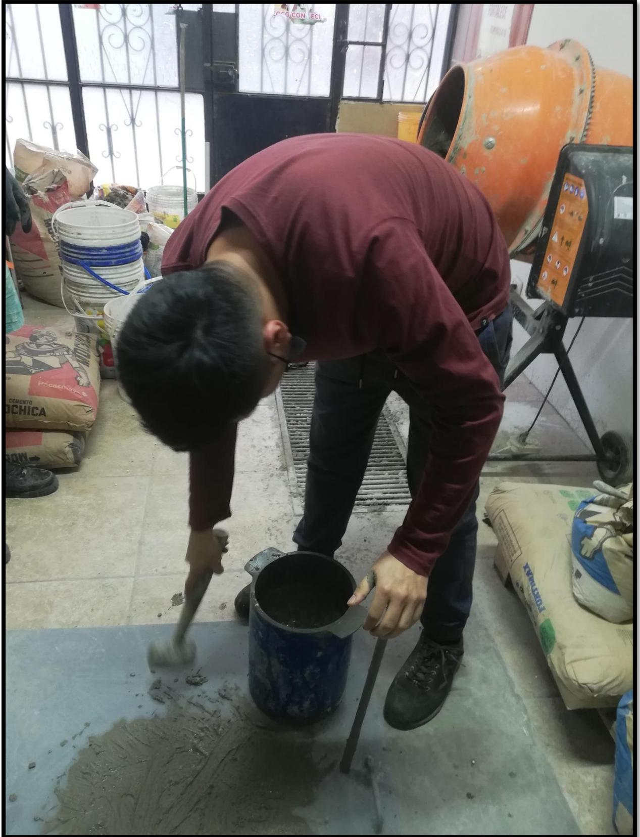
Anexo 42: Ensayo peso unitario del concreto - 3 de 3
