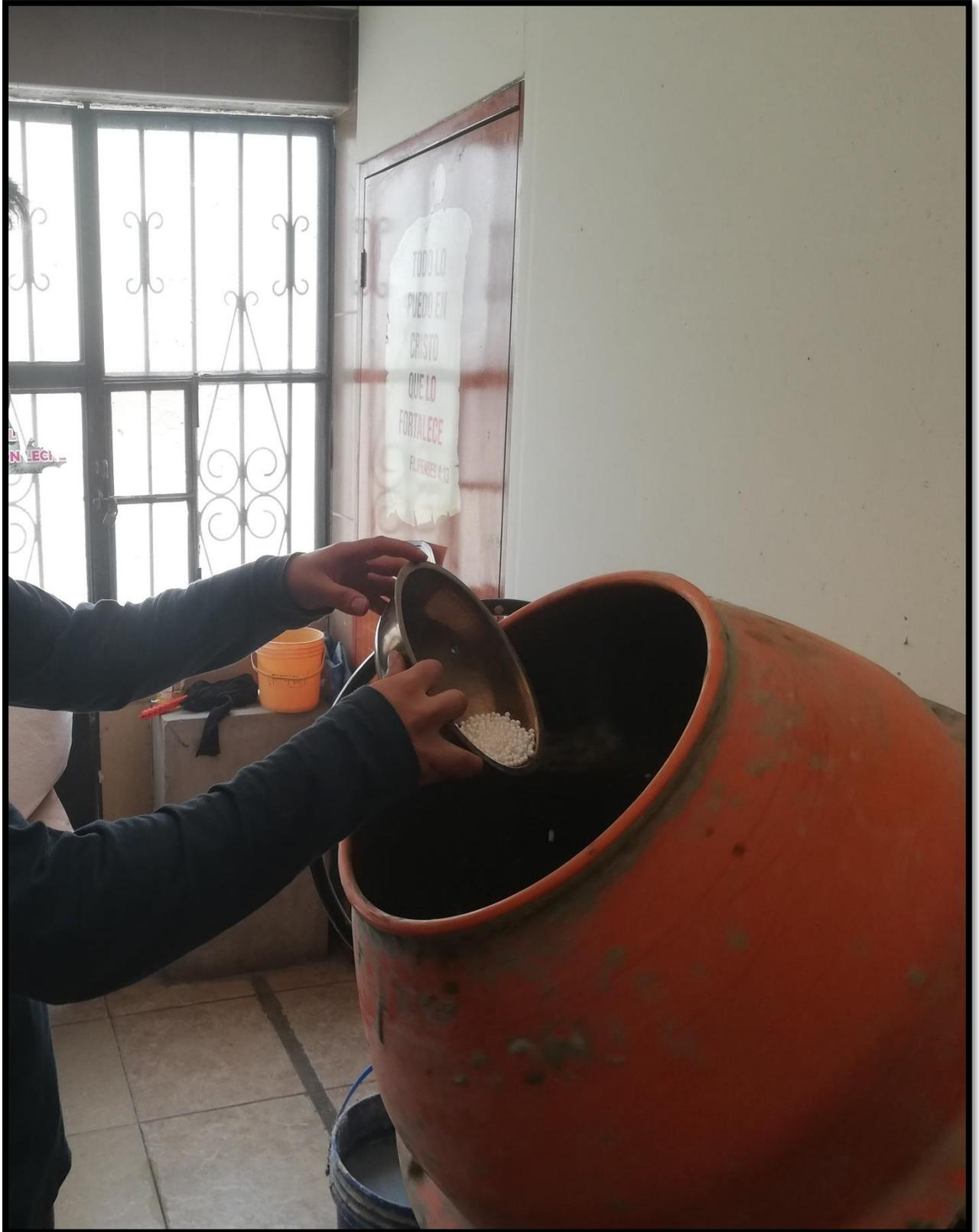
Anexo 45: Llenado de probetas con concreto adicionando perlas de poliestireno expandido
