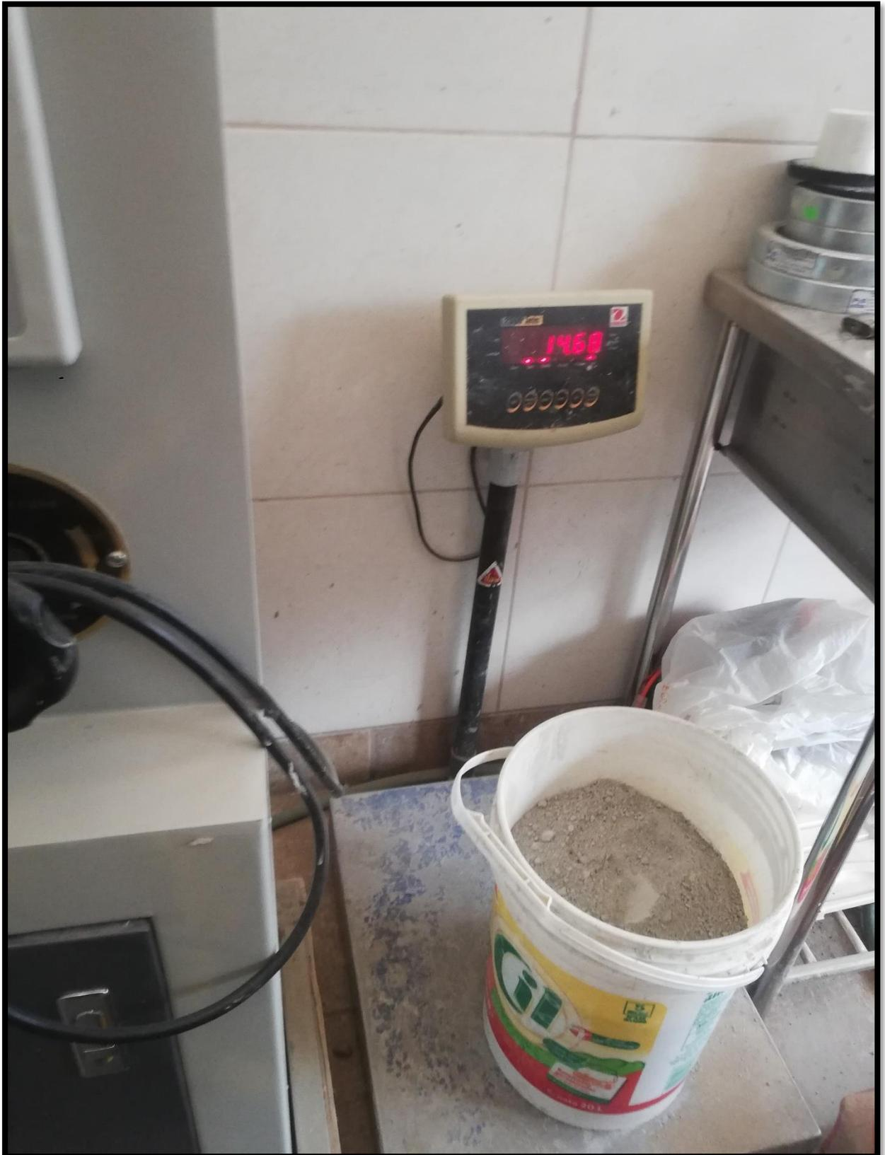
Anexo 35: Pesado de materiales a usar en la mezcla diseñada – 2 de 2
