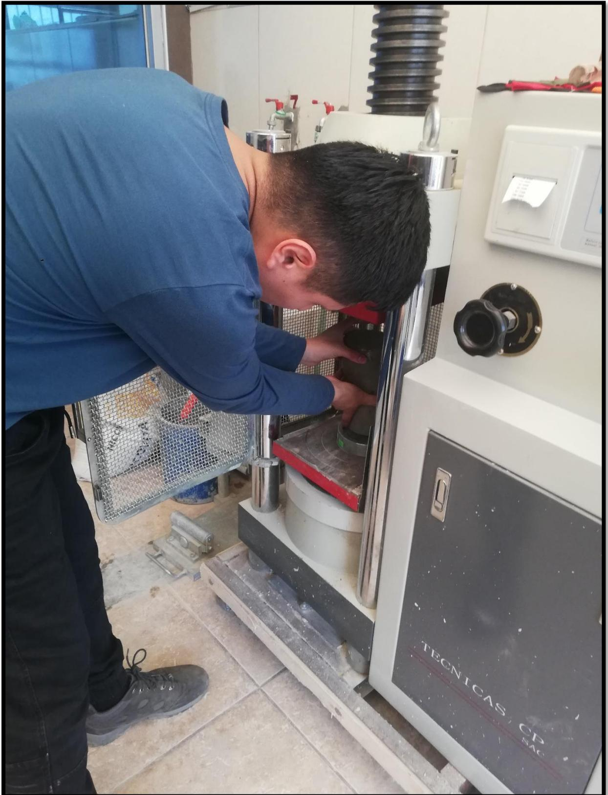
Anexo 56: Ensayo resistencia a la compresión
