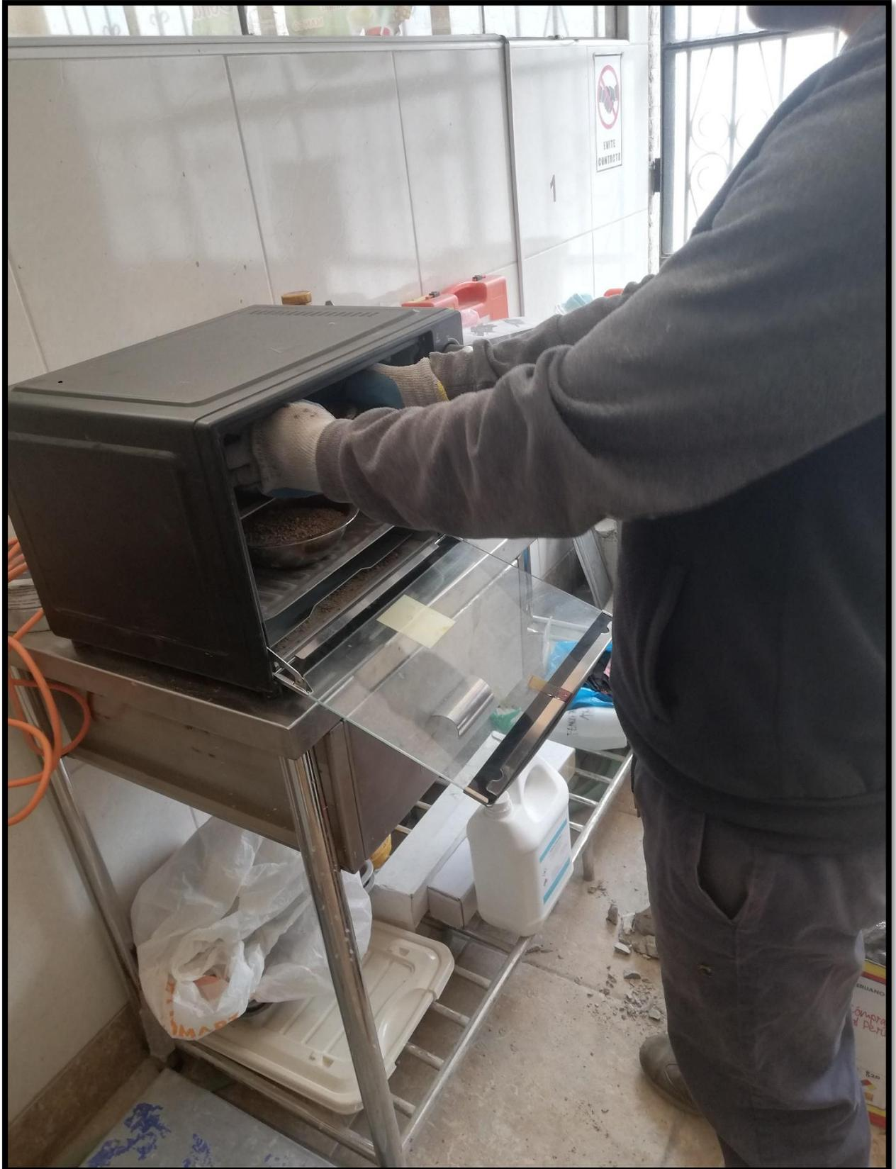
Anexo 22: Ensayo peso específico y absorción del agregado fino – Parte 2
