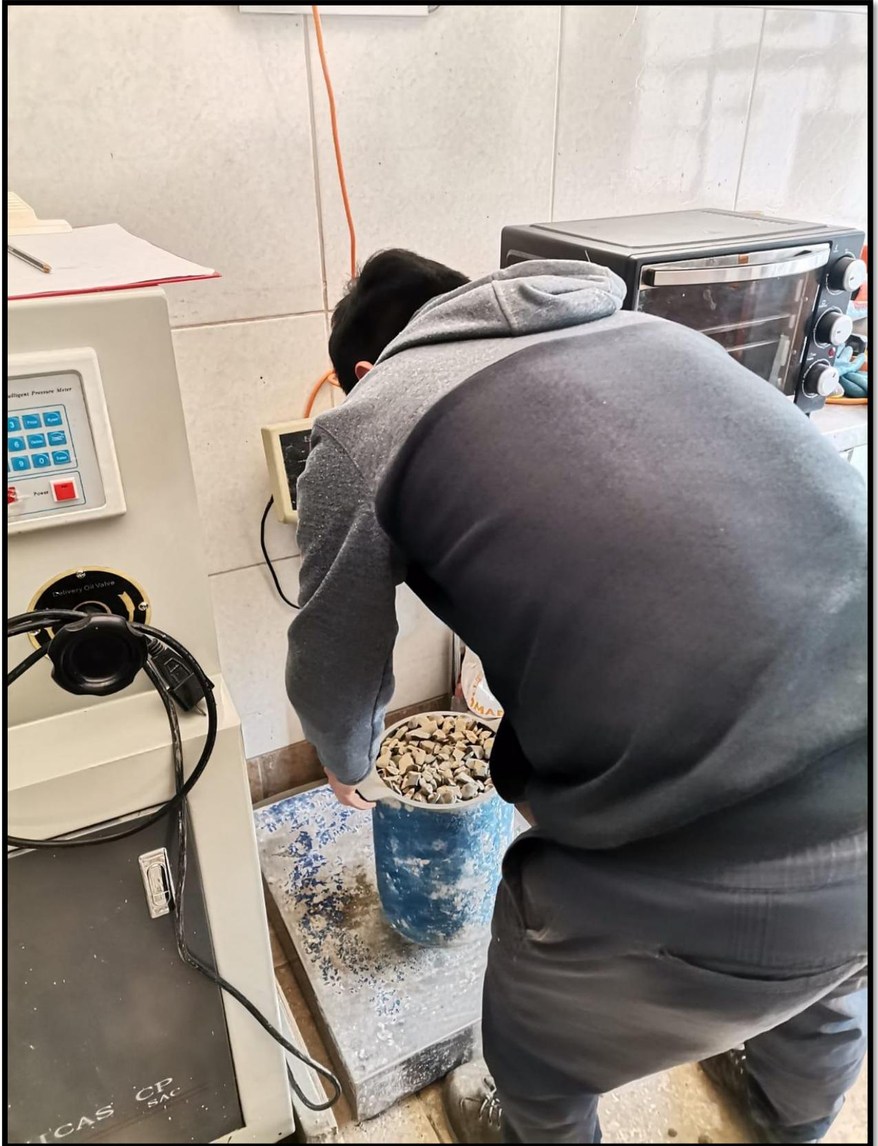
Anexo 30: Ensayo peso unitario compactado del agregado grueso
