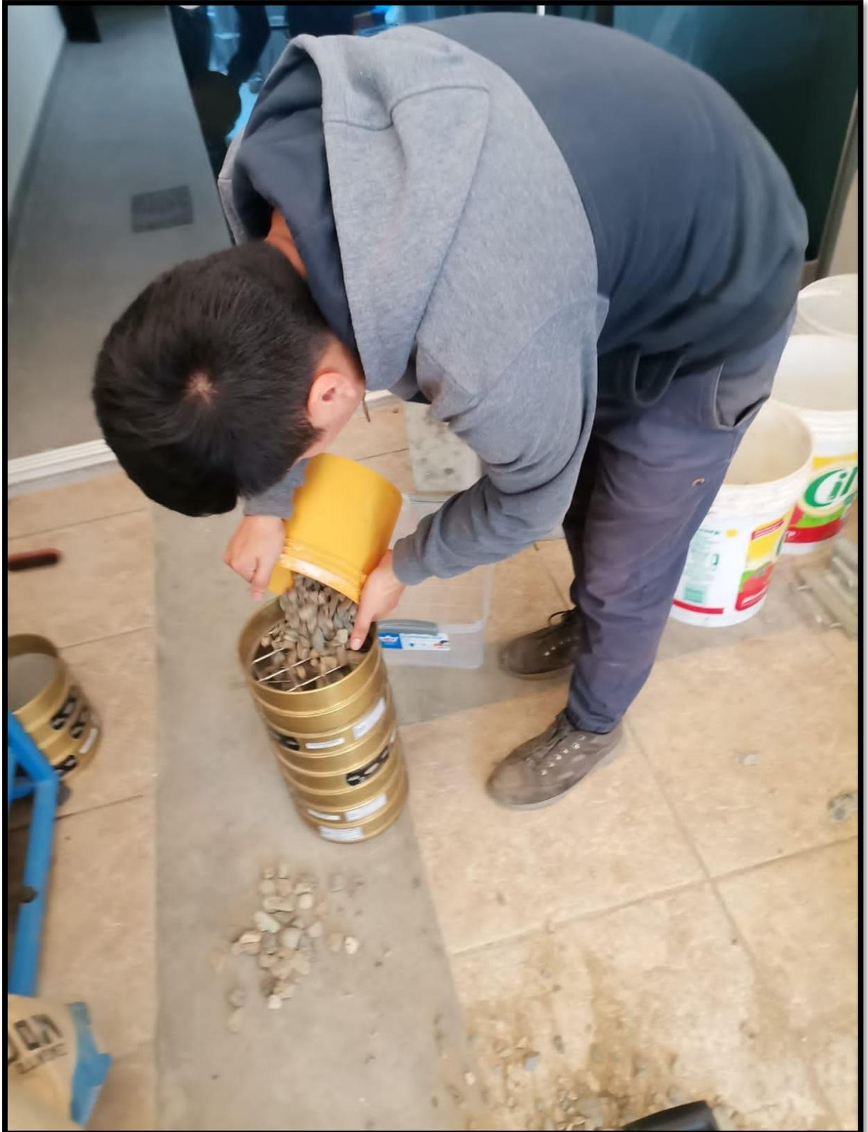
Anexo 27: Agitación manual de tamices para ensayo granulométrico Agregado fino
