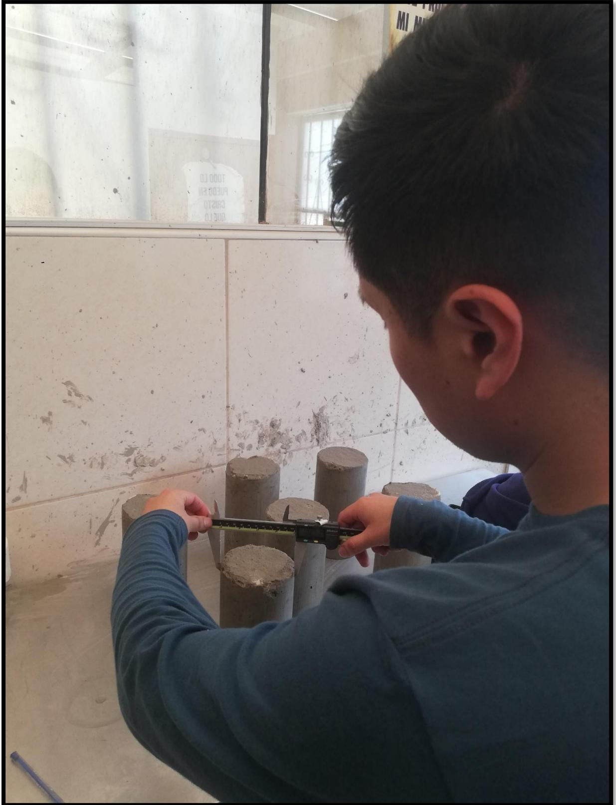
Anexo 53: Determinación área sección de las probetas
