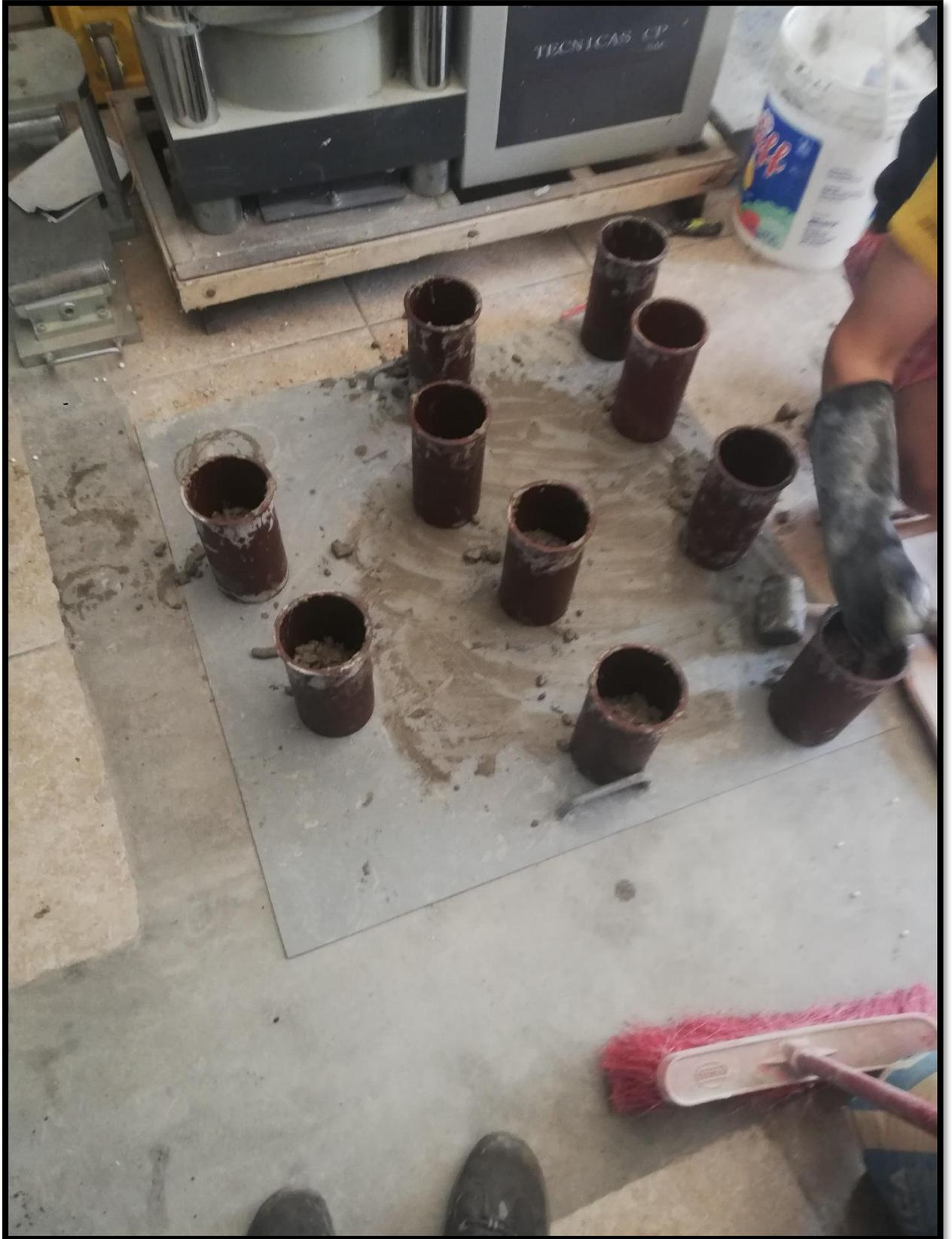
Anexo 46: Elaboración de probetas con adición 10% de poliestireno expandido
