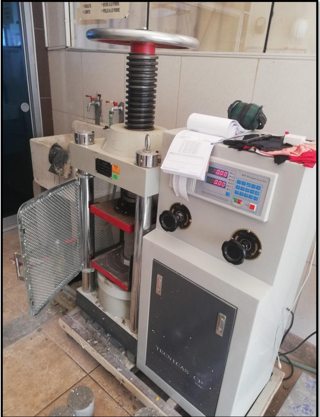
Anexo 55: Preparación de probeta para ensayo resistencia a la compresión
