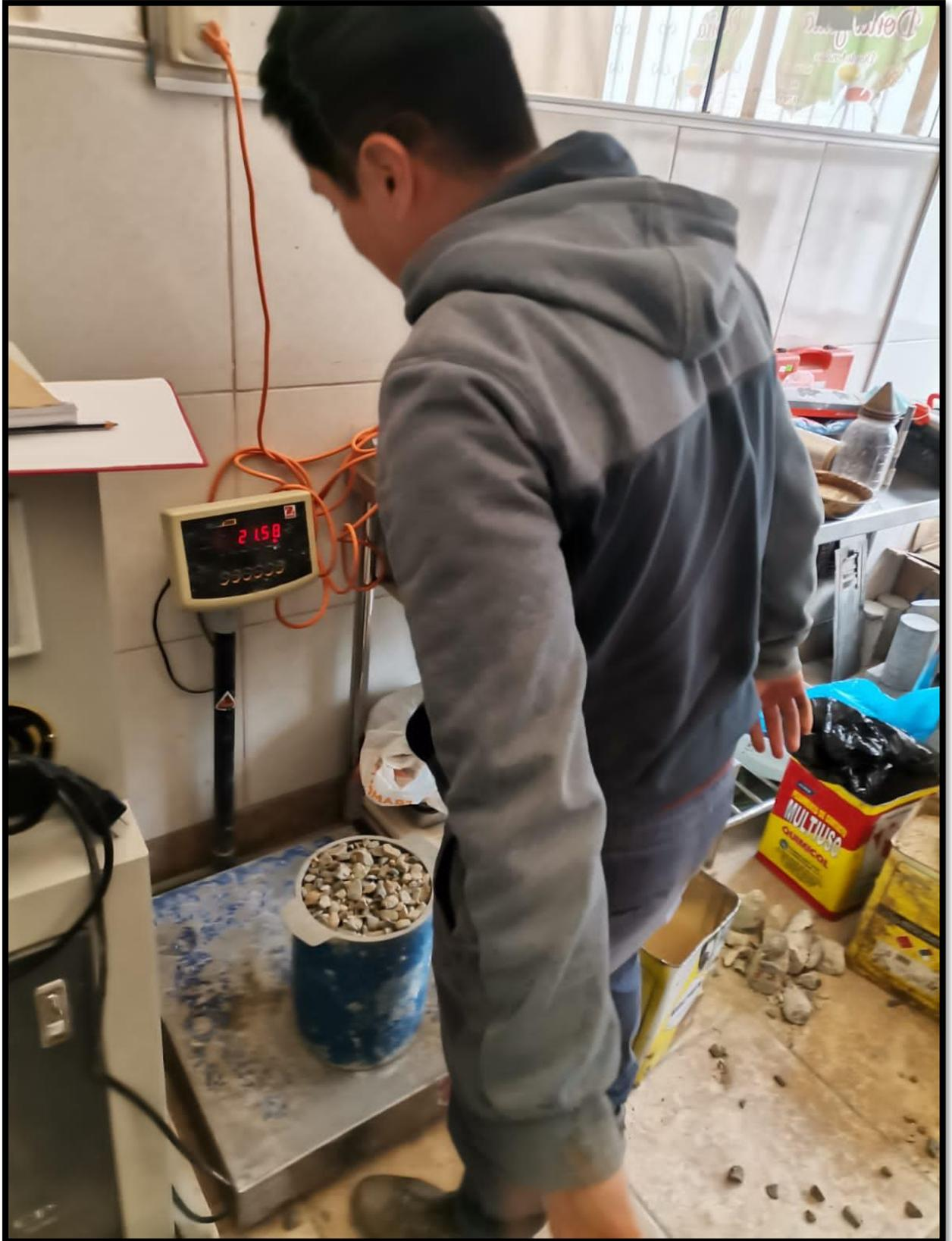
Anexo 32: Ensayo peso específico y absorción del agregado grueso
