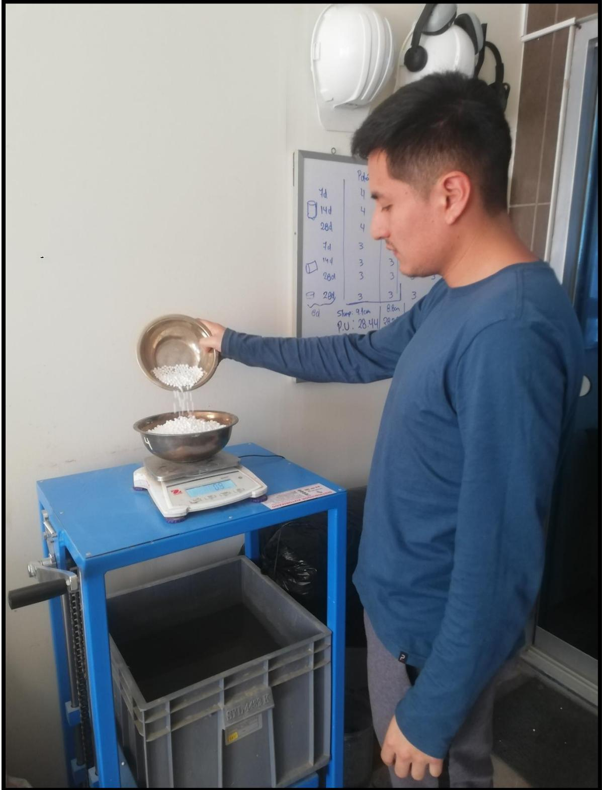
Anexo 44: Elaboración de concreto con adición de perlas de poliestireno expandido
