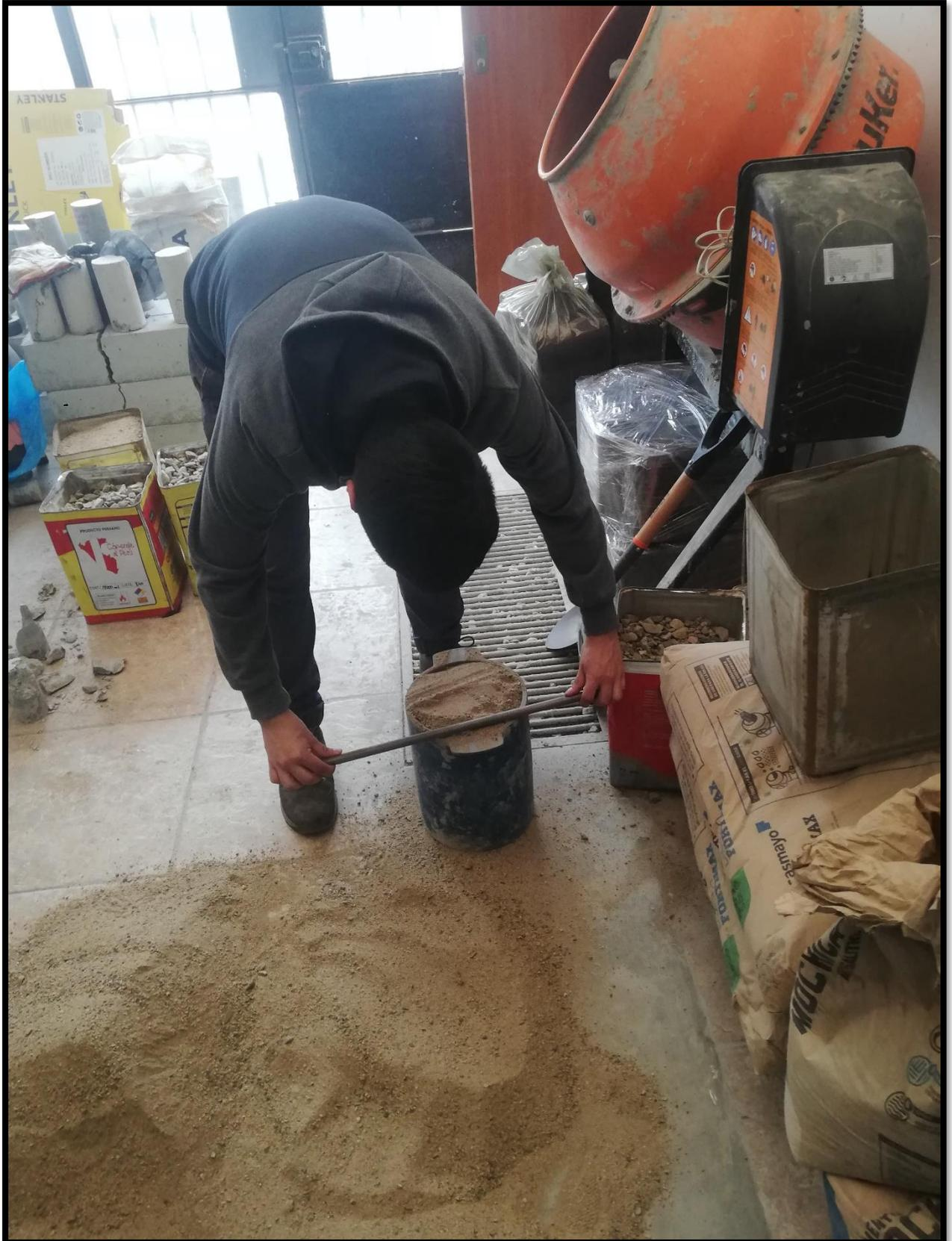
Anexo 19: Ensayo peso unitario compactado agregado fino (1)
